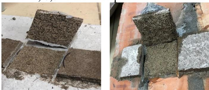
**Рисунок 20** – Проведение испытаний на адгезию строительного раствора на БВЩА от основания
