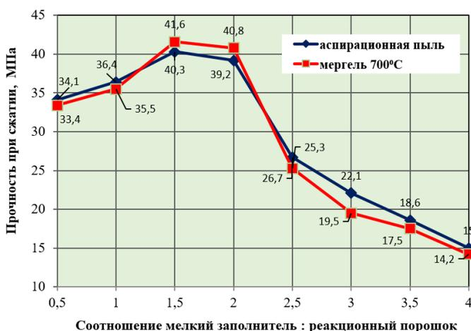
**Рисунок 21** – Исследование влияния соотношения М.З./ПК на прочность бетона
