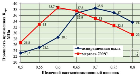
**Рисунок 22** – Зависимость влияния отношения ЩР/ПК на кубиковую (а) и призмную (б) прочности
