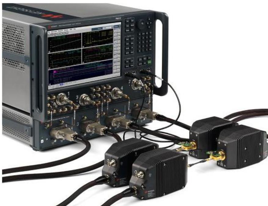
Система измерительная N5290A поставляется предварительно с конфигурированной для работы в диапазоне частот от 900 Гц до 110 ГГц. Для нее предусмотрены пять различных опций. Каждая из рассмотренных ниже опций поставляется с 2- или 4-портовым ВАЦ серии PNA или PNA-X, контроллером измерительного блока N5292A миллиметрового диапазона длин волн для 2- или 4-портовых измерений и блоками расширения частотного диапазона N5293AX03 до 110 ГГц.
