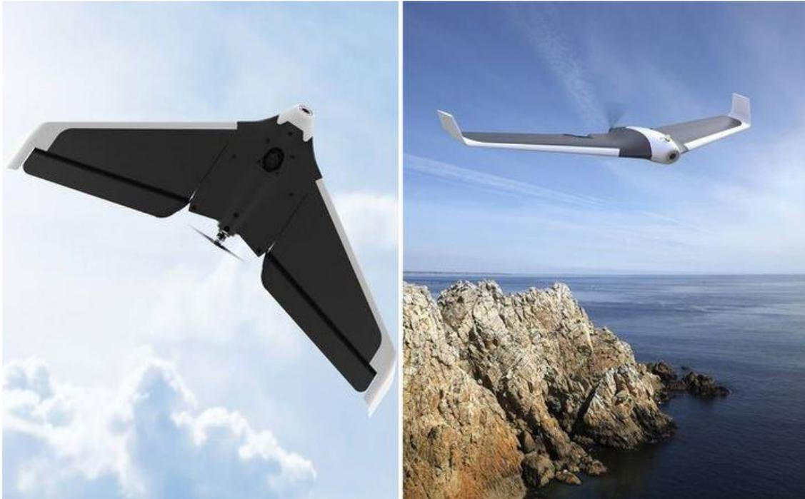
Дрон-самолет Discоспособен развивать высокую скорость, оснащен качественной FPV камерой с подвесом, умеет самостоятельно взлетать и приземляться. Передача видеосигнала происходит на смартфон пилота, можно использовать комплектную VR-маску. И, самое главное, время полета достигает 45 минут. С максимальной скоростью 80 км/ч
