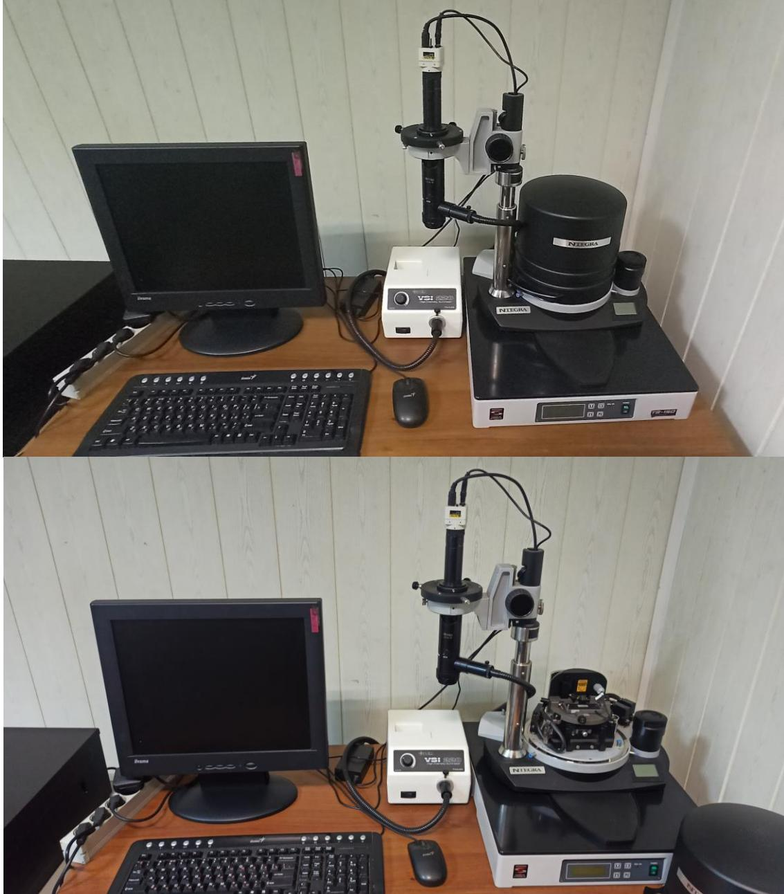
**NTEGRA AURA** является высокоэффективным исследовательским комплексом методами СЗМ в вакууме, позволяя выходить на рабочий режим значительно быстрее нежели аналогичные высоковакуумные системы, при этом вакуум, обеспечивающий десятикратное увеличение добротности, достигается всего за 1 минуту! Компактность и легкость в обслуживании являются так же серьезными преимуществами прибора.
