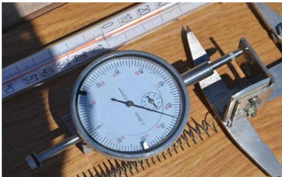
Рисунок 3 – Фото струнного измерителя ширины трещины
