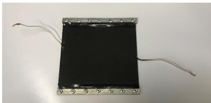
Рисунок 3 – Термоэлектрический модуль, изготовленный по толстопленочной технологии
