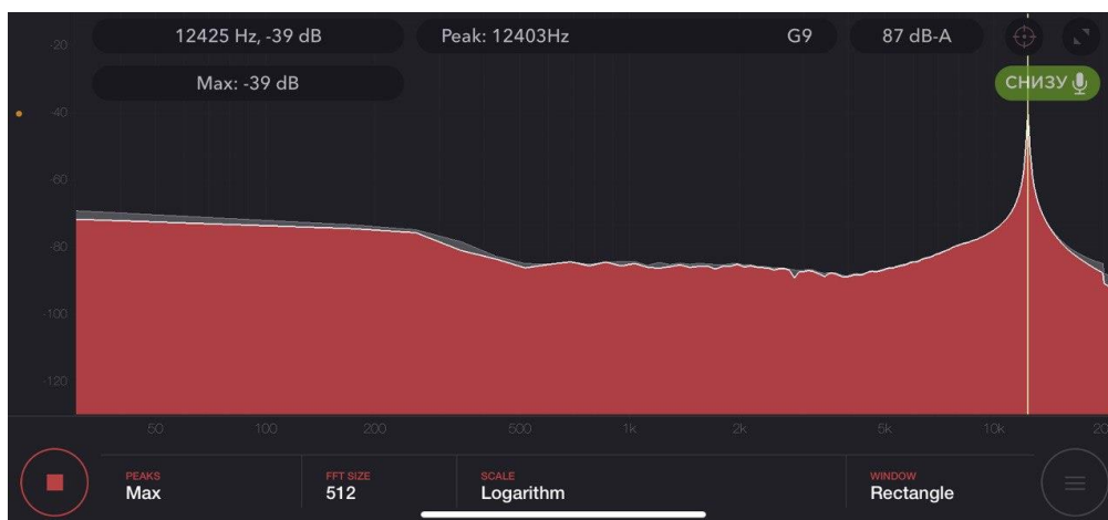
Рисунок 3 – Форсунка с плохим распылом (максимальная частота 12 425 Гц)
