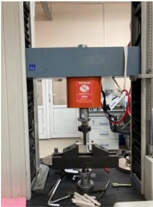
Рис. 6.7. Универсальная испытательная машины Gotech Testing Machine GT-TCS 2000 (Тайвань)
