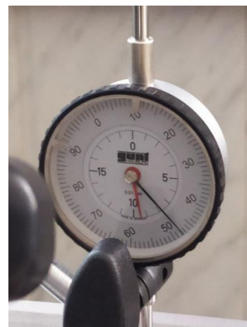
Рисунок 6.23 – Индикатор для измерения перемещений 0 ÷ 50 мм.
