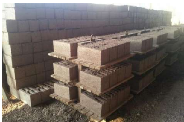
Рисунок 12 – Стеновые блоки на основе керамического кирпичного боя
