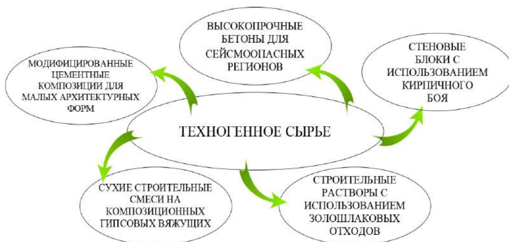
Рисунок 3 – Техногенное сырье для получения бетонов и различных строительных материалов
