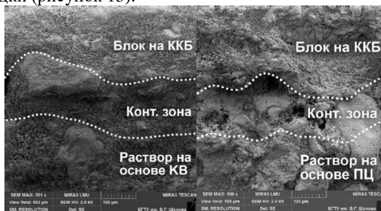
Рисунок 13 – Контакт блока на основе ККБ с раствором на основе КВ (а) и портландцемента (б)
