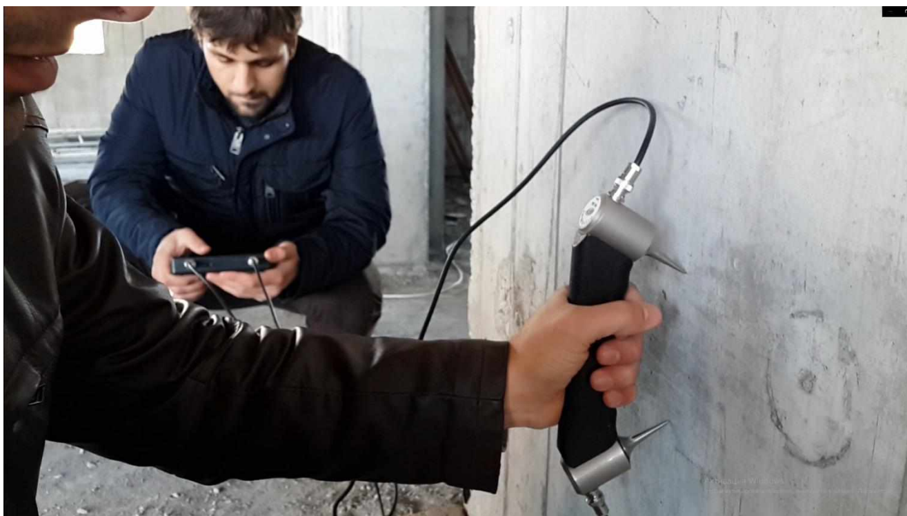
Рисунок 8.6 – Контроль качества бетона конструкции: лаборанты испытательной лаборатории ГНТУ им. акад. М.Д. Миллионщикова во время определения физико-механических свойств монолитных конструкций неразрушающими методами
