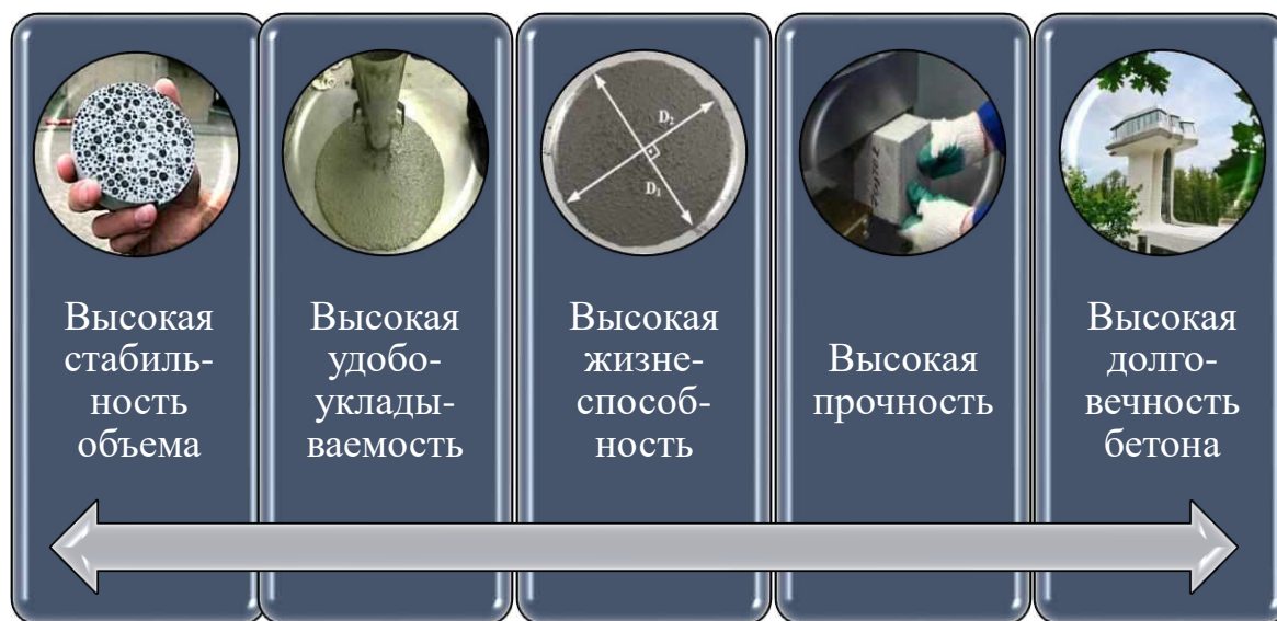
Рисунок 3.2 – Целевые характеристики высокопрочных бетонов
