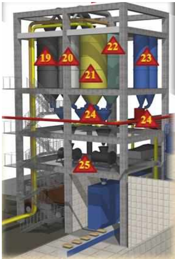
Рисунок 6.11–Растворосмесительный цех для приготовления строительных растворных смесей на мелких песках с использованием комплексной модифицирующей добавки: 19 - емкости хранения мелкого песка; 20- емкости хранения отсева дробления; 21- емкость хранения комплексной модифицированной добавки; 22-емкость хранения цемента; 23- емкость хранения воды; 24- дозаторы; 25-растворосмесители.
