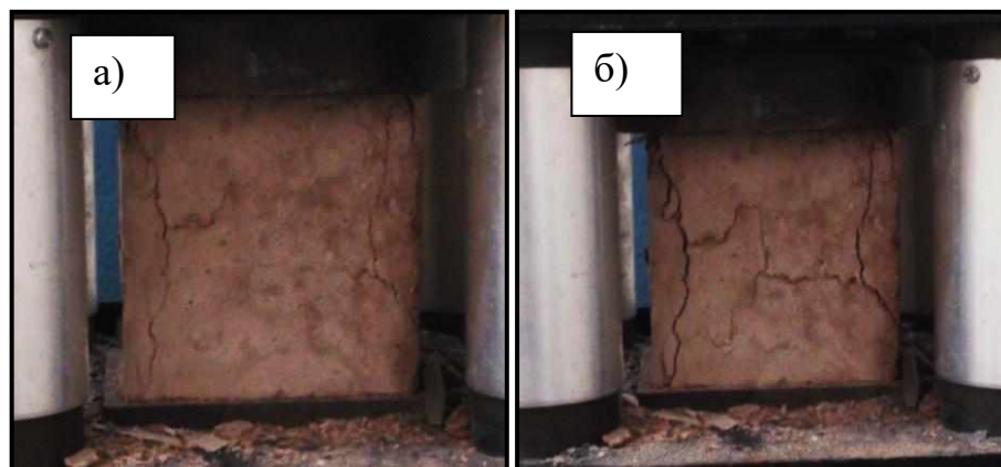
Рисунок 5.4 – Разрушение образцов легкого бетона: а – трещинообразование; б – раскрытие трещин
