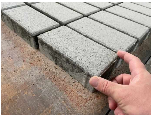
Рисунок 8.11 – Опытная партия мелкоштучных элементов мощения из мелкозернистого бетона на основе отсевов дробления бетонного лома, выпущенная на технологической линии ООО «СтройГрупп»
