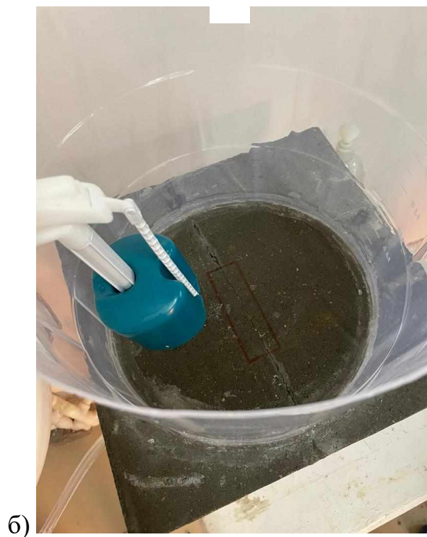
Рисунок 3.31 – Установки для определения скорости самовосстановления трещины в образце: а – схема установки; б – подготовка образца с искусственной трещиной; в - общий вид установки.
