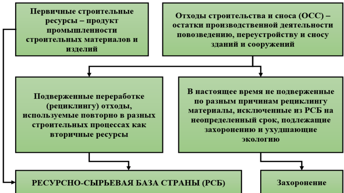
Рисунок 1.14 – Схема использования твердых отходов [224]
