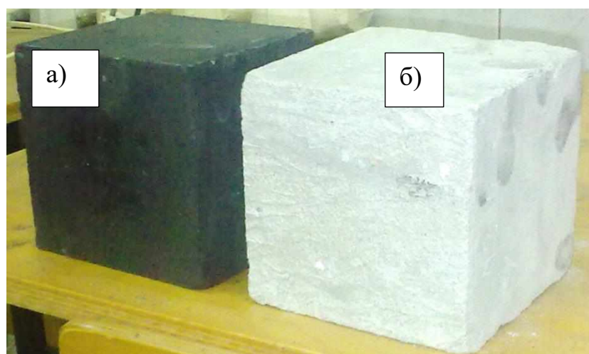
Рисунок 6.12 – Цветовые оттенки строительных растворов: а – с использованием золошлаковых добавок в виде КМД; б – с использованием мелких некондиционных песков (белых песков)
