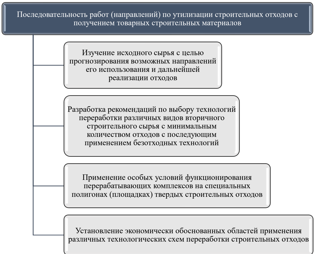
Рисунок 1.15 – Этапы работ (направлений) по использованию строительных отходов для получения строительных материалов [233]
