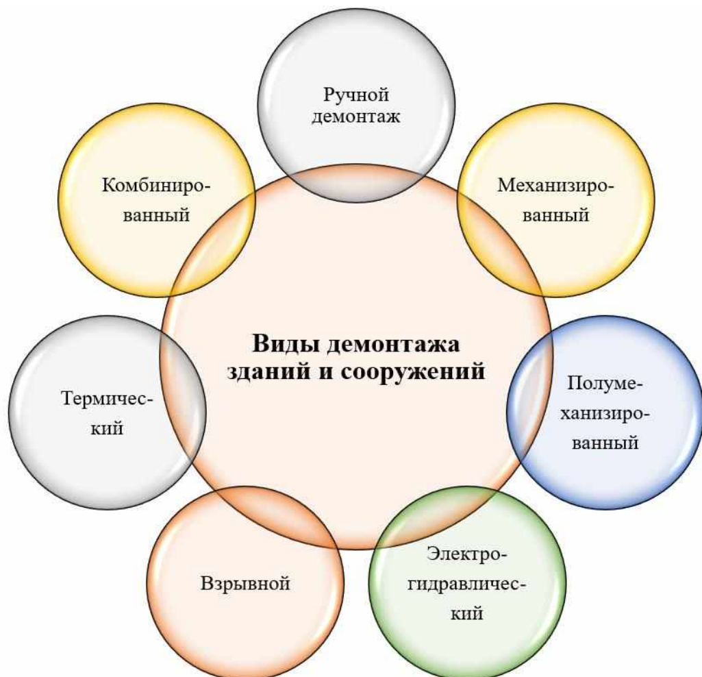
Рисунок 1.19 – Разновидности демонтажа зданий и сооружений
