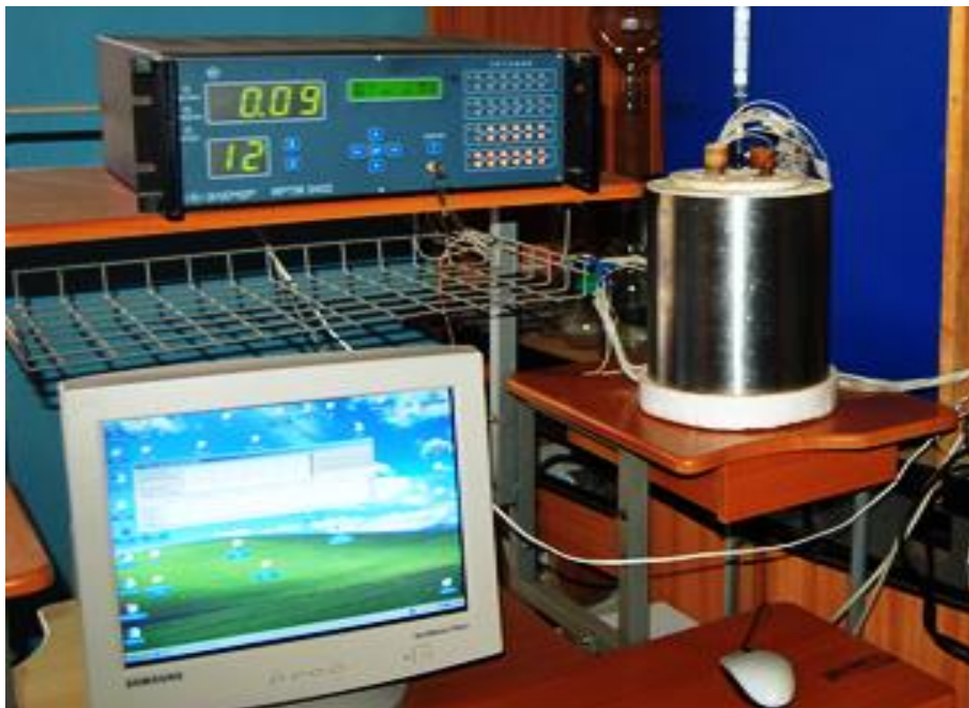
Рисунок 3.2 - Внешний вид экспериментального стенда для исследования охлаждающей ТЭС, используемой при проведении тепловых косметологических процедур
