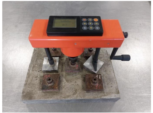
Рисунок 2.15 – Определение прочности сцепления со стандартным бетонным основанием
