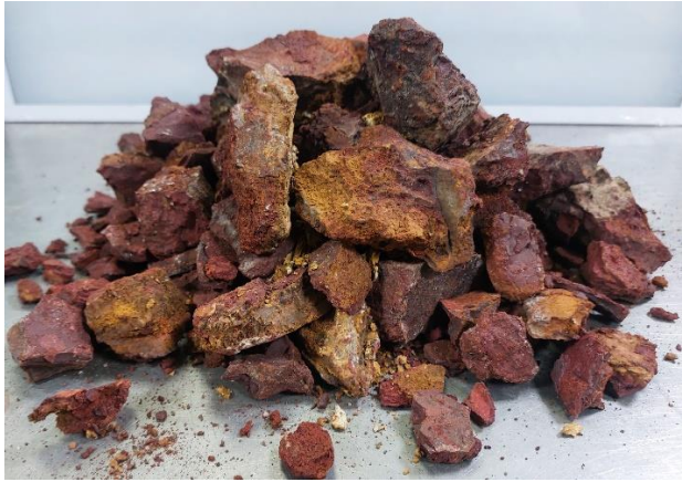
Рисунок 2.9 – Внешний вид горелой шахтной породы Шахтинско-Несветаевского геолого-промышленного района Ростовской области
