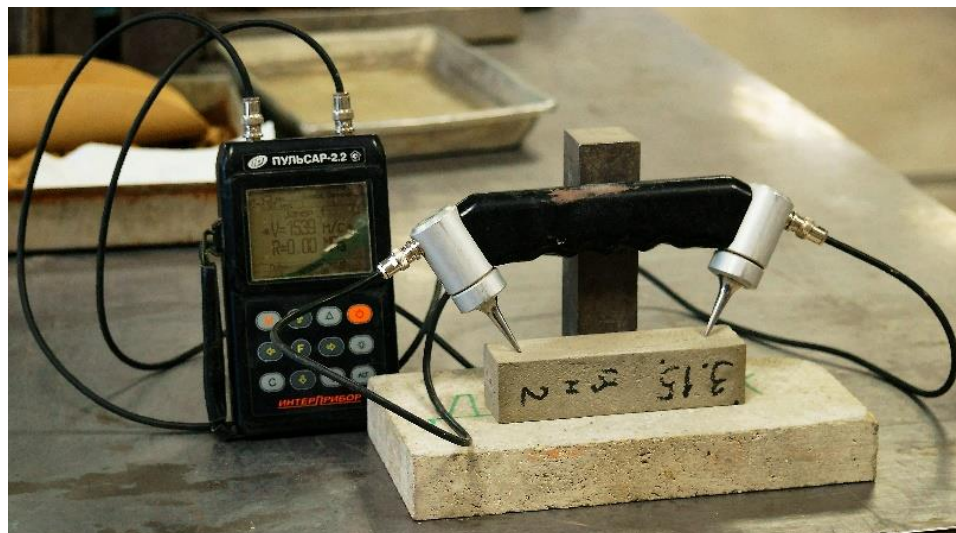
Рисунок 2.14 – Определение скорости ультразвука
