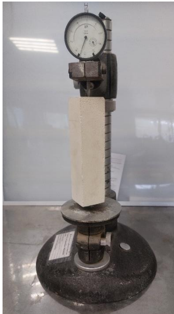
Рисунок 2.12 – Измерение усадочных деформаций, где 1 – стойка; 2 – кронштейн; 3 – конусообразный выступ; 4 – нижняя опора; 5 – индикатор; 6 – образец; 7 – репер; а – размер стороны поперечного сечения образца; Н – высота образца; L_1 – база измерений
