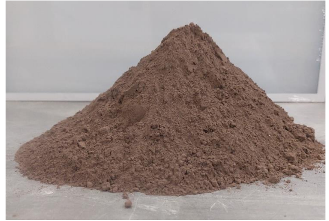
Рисунок 2.9 – Внешний вид горелой шахтной породы Шахтинско-Несветаевского геолого-промышленного района Ростовской области
