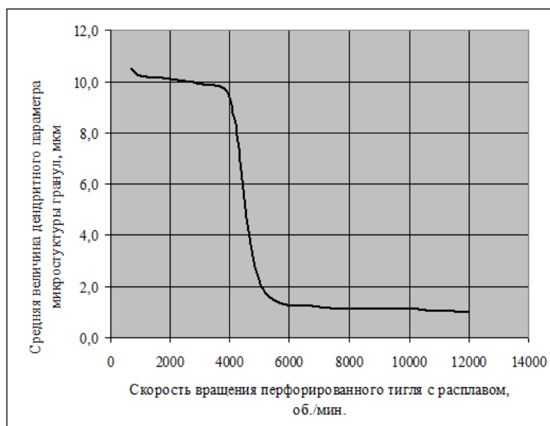
Рисунок 3 – Экспериментально полученная зависимость дендритного параметра микроstructures гранул сплавов В95 и В96Ц диаметром 1,0 мм в зависимости от скоростей вращения перфорированного тигля с расплавом
