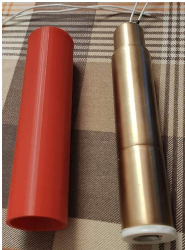
Рисунок 4.8 - Внешний вид ТЭУ для извлечения ИО из тела человека с использованием для отвода теплоты от горячих спаев ТЭМ предварительно захолаживаемого радиатора
