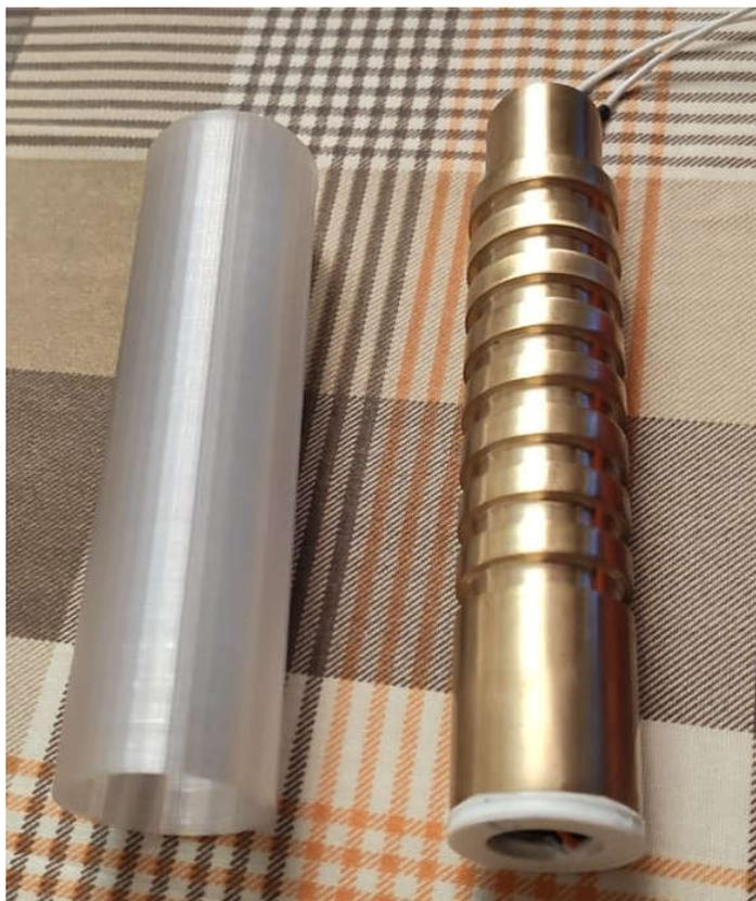
Рисунок 4.2 - Внешний вид ТЭУ для извлечения ИО из тела человека с естественным воздушным отводом теплоты от горячих спаев ТЭМ
