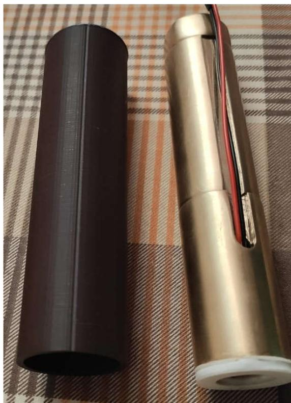
Рисунок 4.5 - Внешний вид ТЭУ для извлечения ИО из тела человека с использованием для отвода теплоты от горячих спаев ТЭМ плавящегося рабочего вещества
