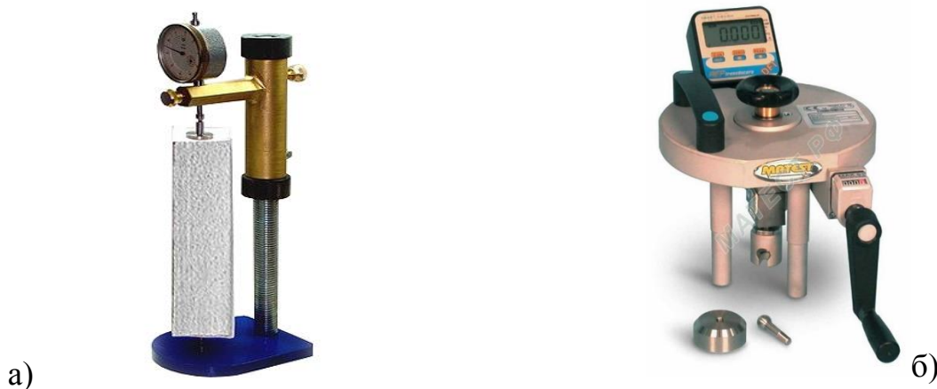
Рисунок 2.5 – Установки для определения свойств ремонтных составов а) прибор УБ-40 для определения усадочных и линейных деформаций расширения; б) прибор адгезиметр Е142 для определения адгезионной прочности
