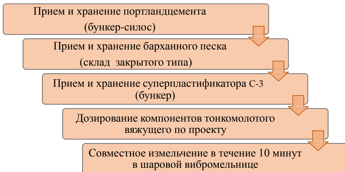
Рисунок 4.1 – Схема приготовления тонкомолотого вяжущего
