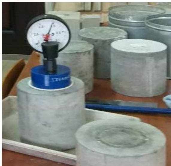
Рисунок 2.4 – Испытания ремонтного бетона на водонепроницаемость с использованием прибора ВВ-2
