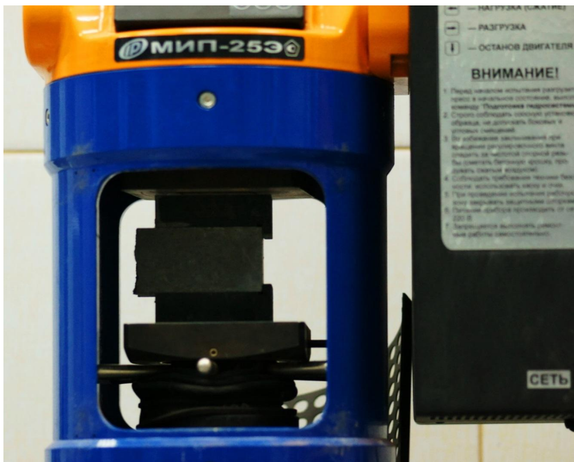
Рисунок 2.2 – Испытание половинки балочки 40x40x160 мм на сжатие
