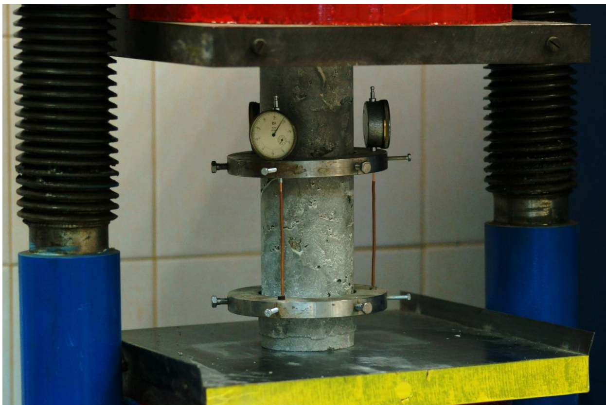
Рисунок 2.6 – Измерение деформаций при испытаниях образцов-цилиндров для определения параметров диаграммы «напряжения – деформации»
