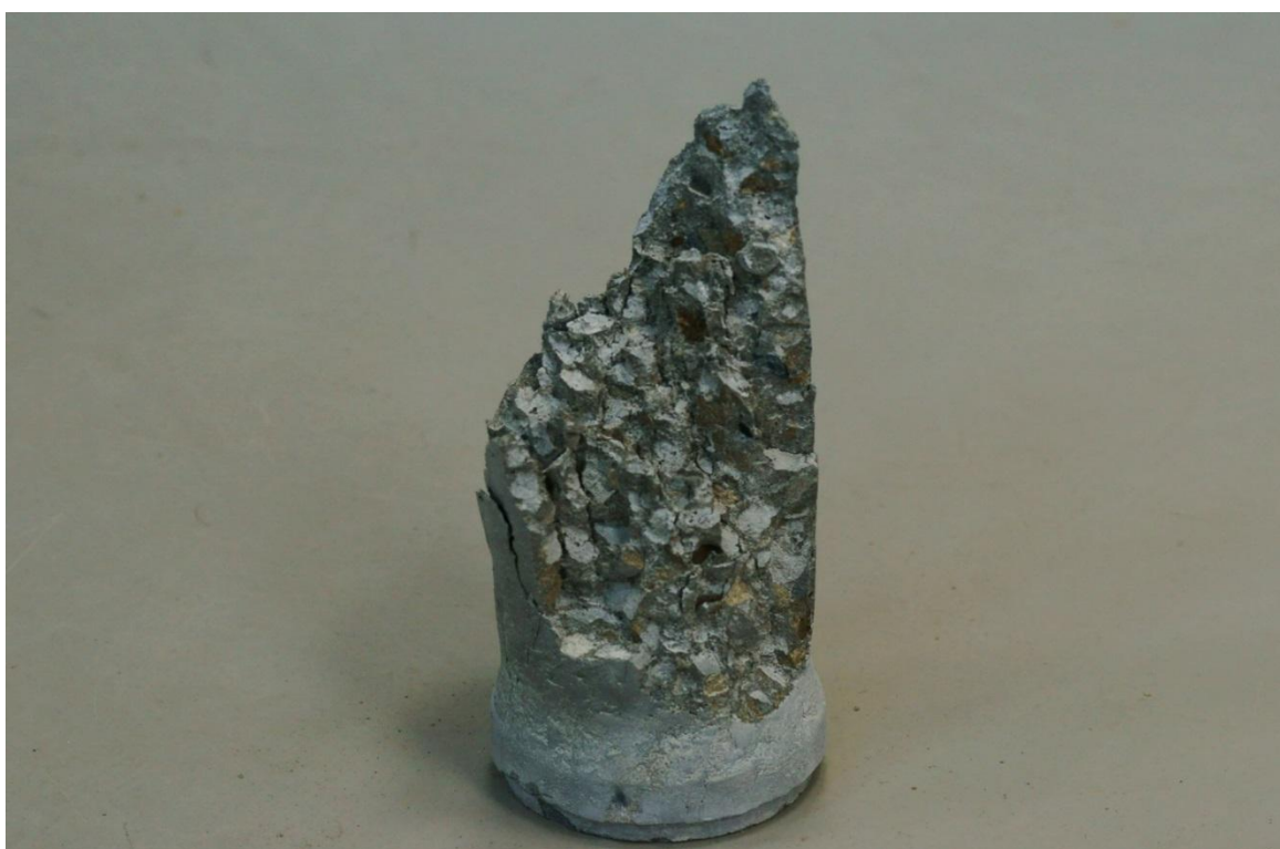
Рисунок 3.12 – Характер разрушения бетонного образца, полученного по технологии 2 (погружение) при испытании на сжатие
