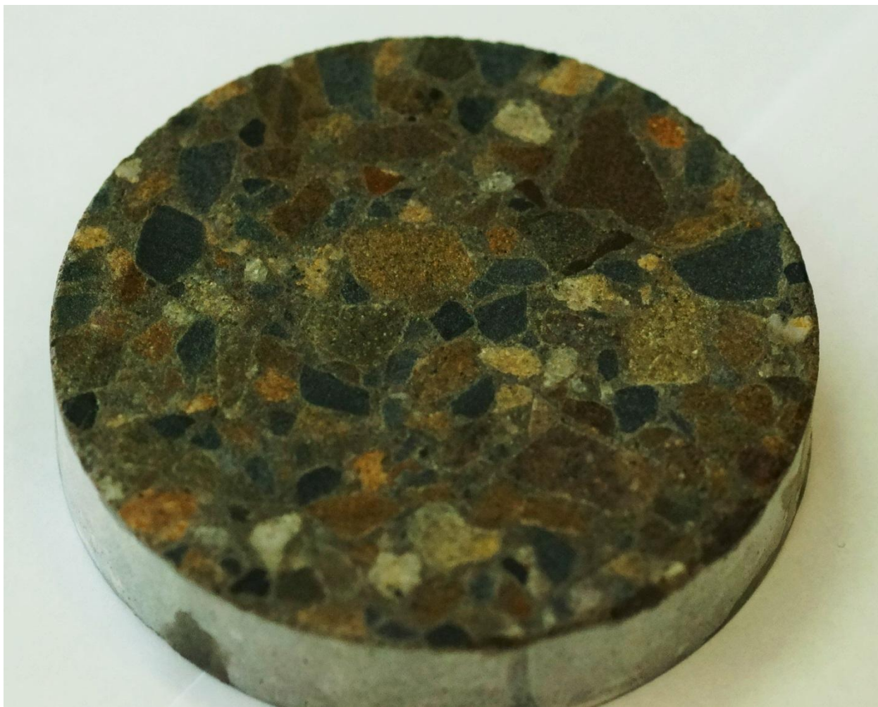
Рисунок 3.10 – Структура бетона, полученного по технологии 2 (погружение); реальный диаметр образца 95 мм; крупный заполнитель фракции 5 – 20 мм
