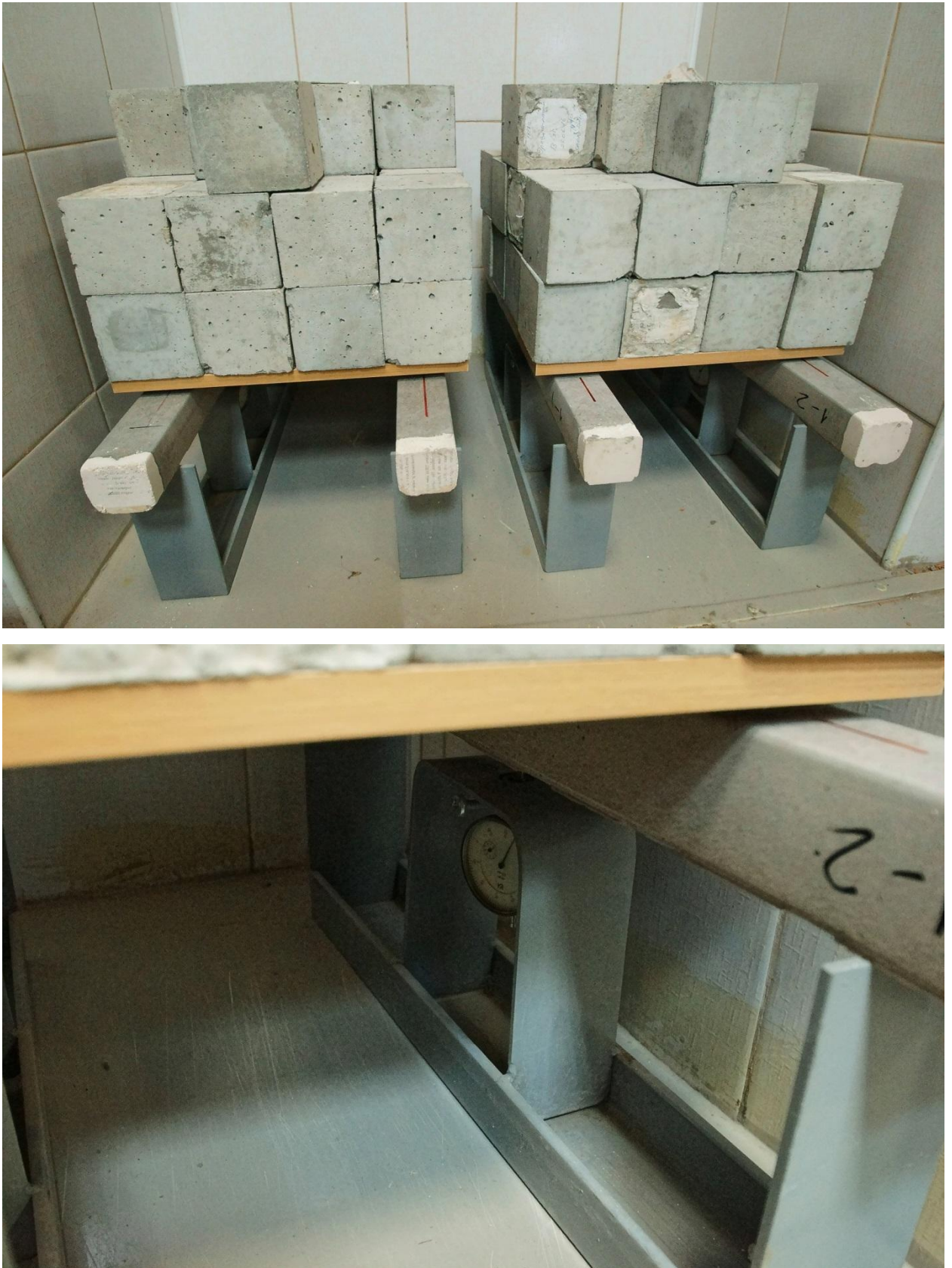
Рисунок 2.7 – Общий вид и детали испытаний балок 60x60x600 мм на изгиб при длительном нагружении
