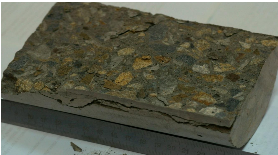
Рисунок 3.11 – Характер разрушения бетонного образца, полученного по технологии 2 (погружение) при испытании на растяжение при раскалывании – разрушение по заполнителю и растворной составляющей
