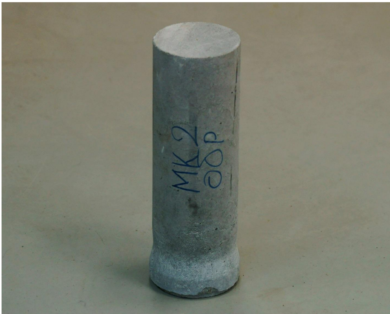
Рисунок 2.3—Образец – цилиндр для определения предела прочности на сжатие и параметров диаграммы «напряжения – деформации» при кратковременном нагружении
