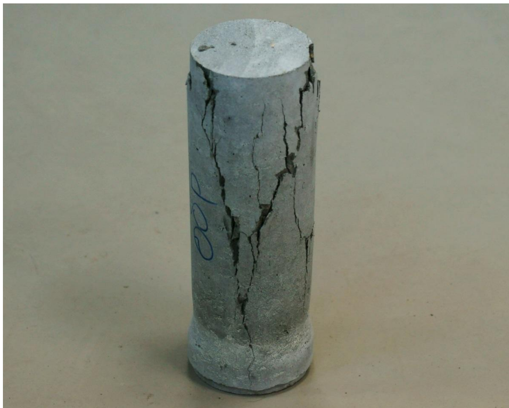
Рисунок 2.4 –Образец – цилиндр 400x100 (d) после испытаний на центральное осевое сжатие при кратковременном нагружении
