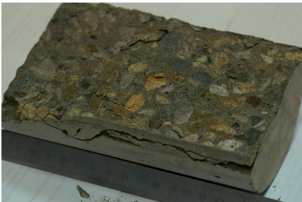
Рисунок 2.5 –Образец – цилиндр 200x100 (d) после испытаний на растяжение при раскалывании при кратковременном нагружении
