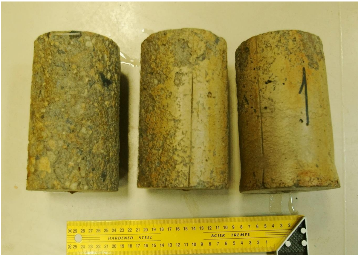
Рисунок 5.8 – Образцы бетона с каркасной структурой после 50 циклов замораживания-оттаивания по 2 методу ГОСТ 10060
