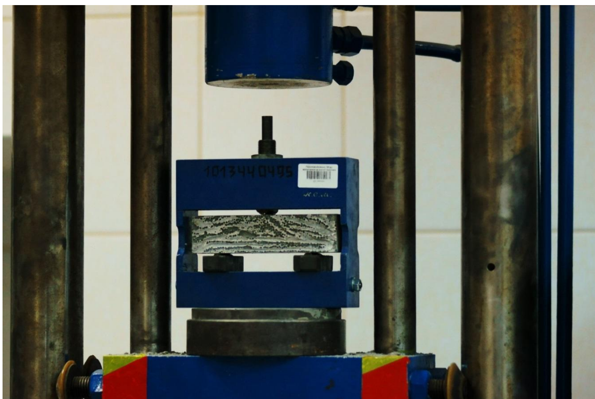
Рисунок 2.1 – Испытание балочки 40x40x160 мм на изгиб
