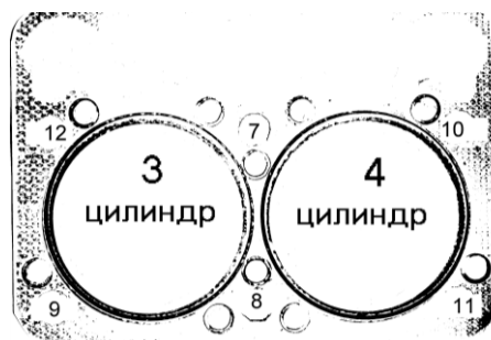
Рисунок 2. Контактные отпечатки на бумаге в стыке блок-картера и головки третьего и четвертого цилиндров.
