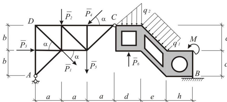
1. Пренебрегая собственным весом стержней и пластины, составить силовые схемы для конструкции в целом и для фермы и пластины в отдельности. Распределённую нагрузку заменить равнодействующей.
