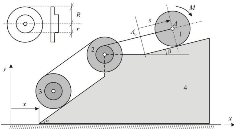
Каток 1 представляет собой сплошной однородный цилиндр массы  $m_1 = 2m$  радиус  $r_1 = 2r$ . Блок 2 и каток 3 — одинаковые сплошные однородные двойные цилиндры массы  $m_2 = m_3 = m$  с внутренним радиусом  $r_2 = r_3 = r$  и наружным радиусом  $R = R = 2r$ .
