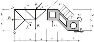
Из девяти возможныхуравнений равновесия (по три для каждой силовойсхемы) выбрать шесть линейно независимых, наиболее удобных для решения задачи, иопределитьизних-составляющиеопорных реакцийи усилиевшарнире С.
