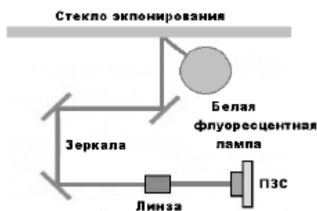
Рис. 3. Расположение элементов в сканере технологии CCD
