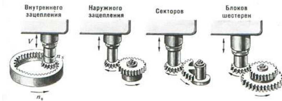
Рис. 4.1. Схема нарезания прямозубых колес на зубодолбежном станке
