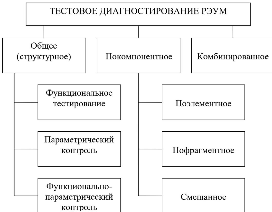
**Рис. 1.1.2.** Методы тестового диагностирования РЭУМ
