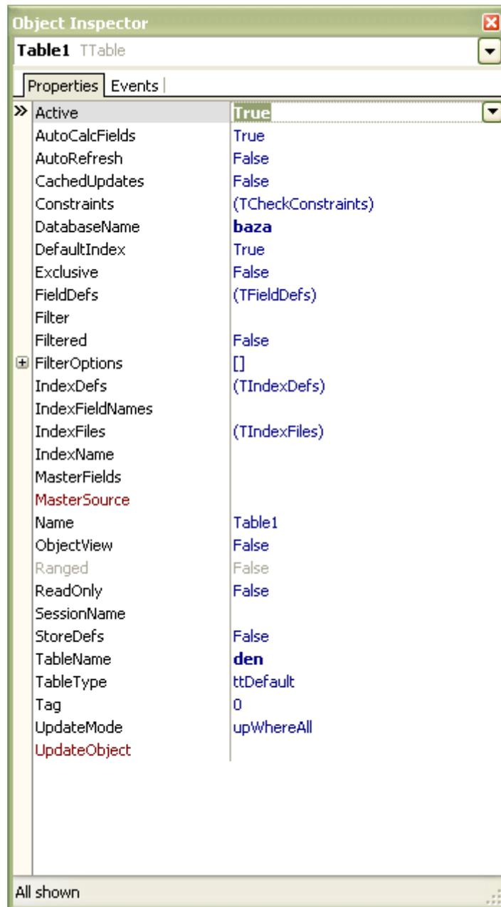
Рис. 10. Свойства компонента Table1
