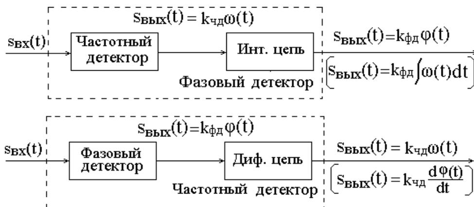
Рис. 8.28. Взаимосвязь между фазовым и частотным детекторами
