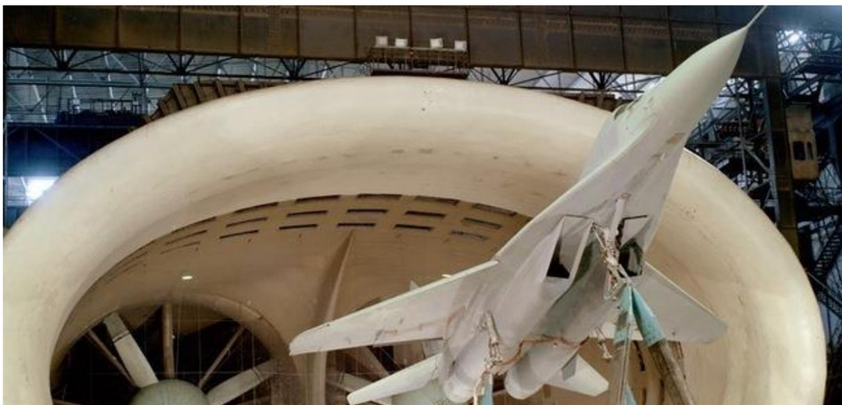
Рис. 7 – Фото самолет Миг-29 в аэродинамической трубе Т-101
