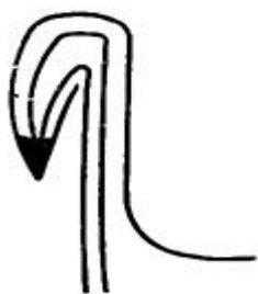
Рис. 32. Углошов из 7 слоев жести
