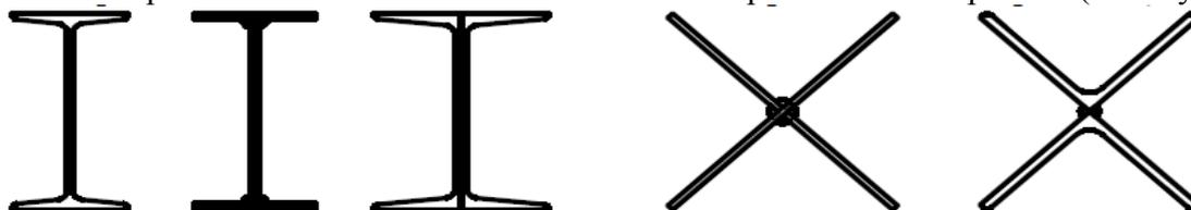
Рис. 13.1. Открытое сечение стержня колонн.
