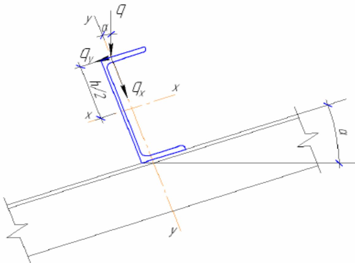
Рис. 22.2. Схема действия нагрузки на прогон
