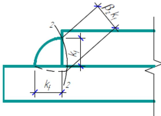
2-2 – плоскость разрушения по металлу границы сплавления.
