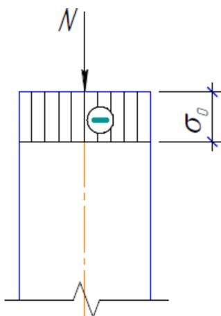
В тот момент, когда стержень имеет прямолинейную форму, нормальные напряжения по сечению распределяются равномерно (т.к. стержень центрально сжат).
