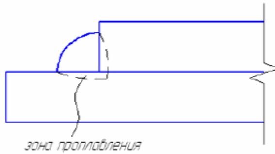
Глубина проплавления зависит от способа сварки.
