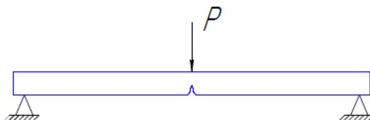
5) загиб полосы в холодном состоянии вокруг оправки на  $180^0$ . Это свойство устанавливает склонность стали к расслоению
