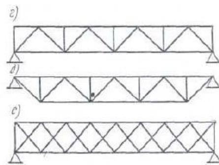
Рис. 15.3. Очертания балочных ферм:
