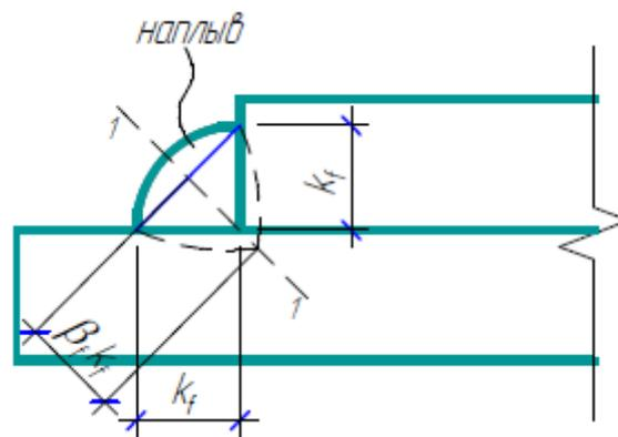
1-1 – плоскость разрушения по металлу шва.
