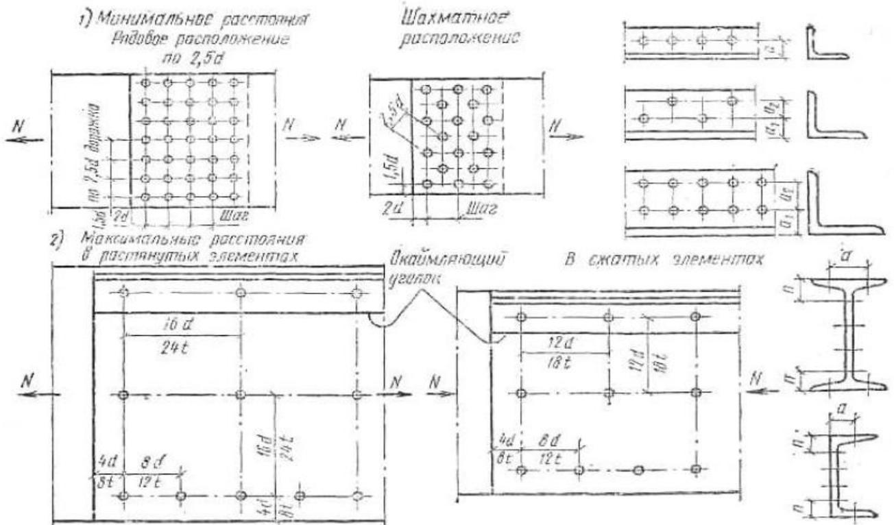
Рис. 10.4. Размещение отверстий.
