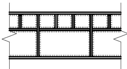
В местах приложения к поясу балки сосредоточенных нагрузок должны быть установлены поперечные ребра жесткости.
