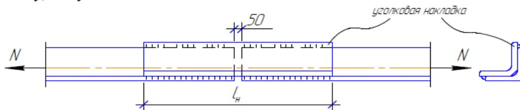
У уголковой накладки обушок срезается. В соответствии со СНиП сварные швы в таком соединении следует накладывать вдоль действующего усилия (фланговые швы). Длина накладок  $l_n$  зависит от длины швов. Требуемая длина швов определяется на половину соединения.
