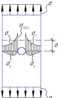
Отношение максимального напряжения в месте концентрации к среднему, равномерно распределенному по сечению, называется **коэффициентом концентрации**.
