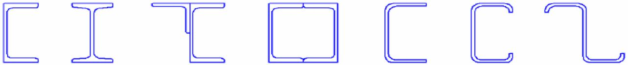
Рис. 22.1. Типы сечения сплошных прогонов
