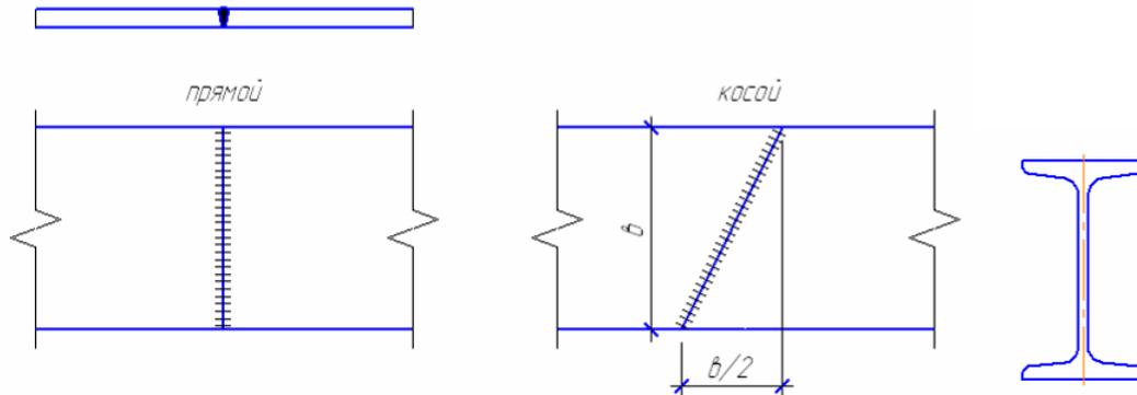
Стыковые соединения наиболее рациональны, так как отличаются экономичностью, качество выполнения таких швов может быть надёжно проверено, они отличаются наименьшей концентрацией напряжений при передаче усилий, толщина свариваемых элементов почти не ограничена. Стыковое соединение листового металла может быть сделано прямым или косым швом. Стыковые соединения профильного металла применяются реже, так как затруднительна обработка их кромок под сварку.
