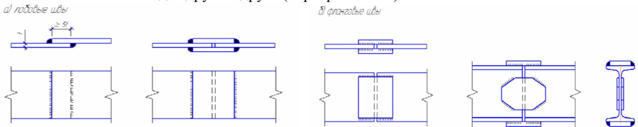
Эти соединения широко применяют при сварке листовых конструкций, в решётчатых и некоторых других видах конструкций.
