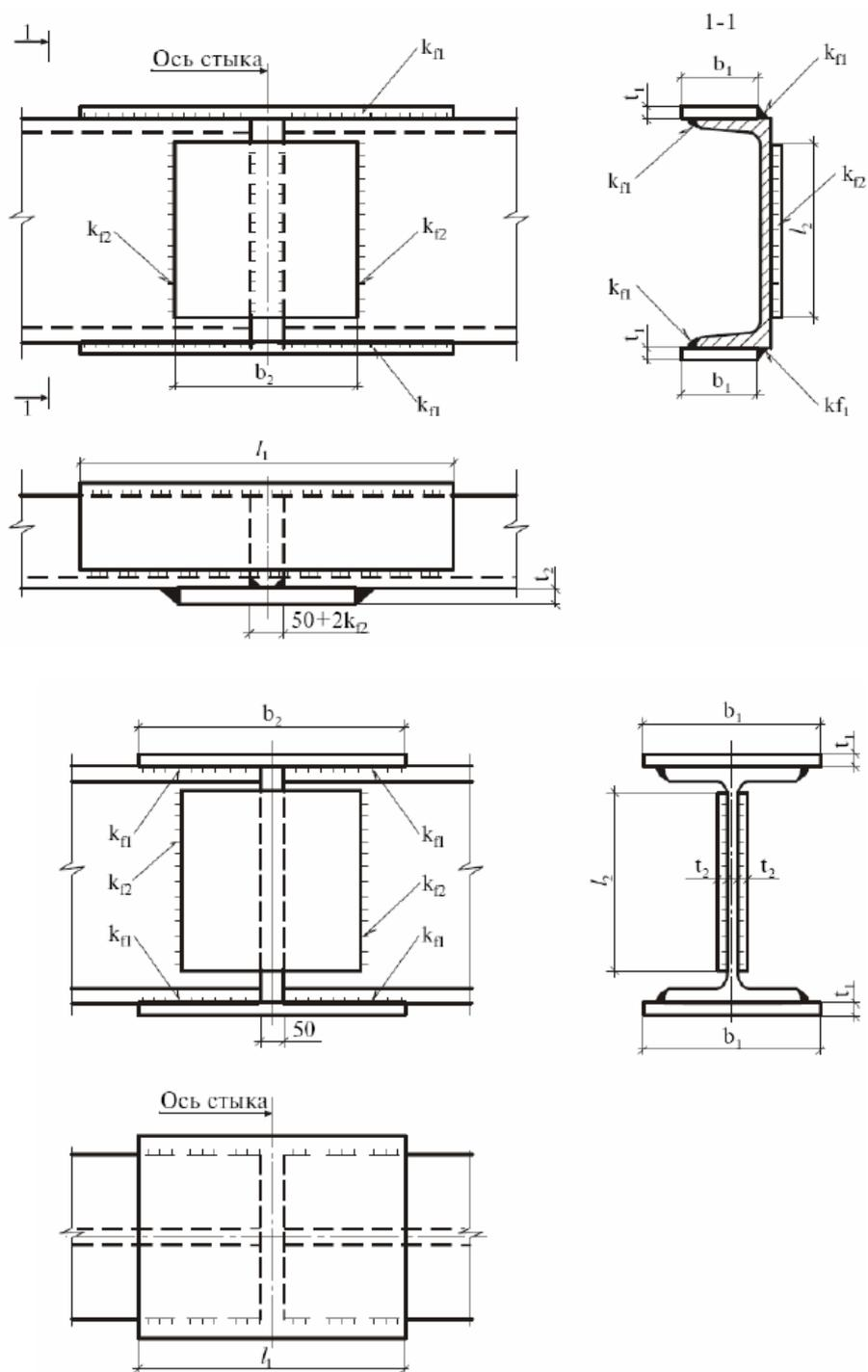
Все размеры накладок определяются расчетом по несущей способности соединяемых элементов.
