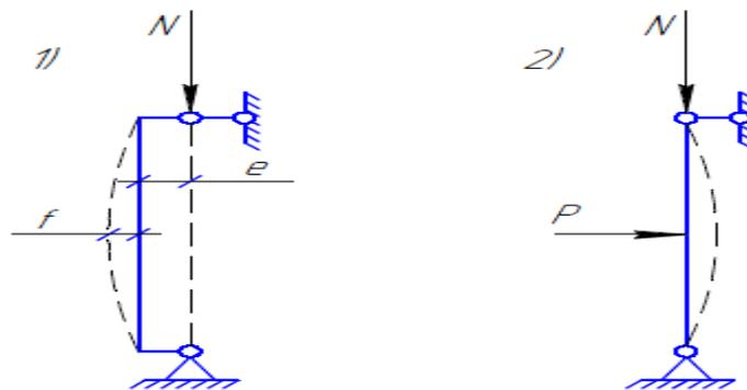
Работа этих стержней несколько отличается друг от друга. Но в целях упрощения расчетов сжато-изогнутые стержни при потере устойчивости рассматривают как внецентренно сжатые с эксцентриситетом  $e=M/N$ . При внецентренном сжатии с самого начала приложения нагрузки возникает изгиб стержня, который увеличивается с ростом нагрузки. Величина нагрузки, при которой изгибные деформации растут при постоянном ее значении или даже уменьшении, называется критической  $N_u$ .
