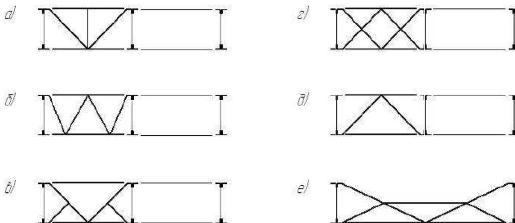
Рис. 18.2. Схемы решеток вертикальных связей между фермами
