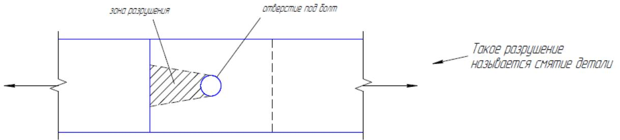
Более равномерно работают болты класса точности А. Различие между работой болтов класса точности А, В, С учитывается в расчетах коэффициентом условия работы соединения ( $\gamma_b$ ) и величиной расчетного сопротивления.
