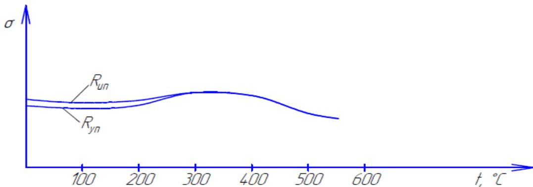
При  $t$  до 200°C  $R_{un}$  и  $R_{уп}$  почти не меняются; при 300°C имеется некоторое повышение.
