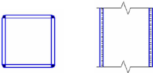
**Тавровые** соединения отличаются от угловых тем, что у них торец одного элемента приваривается к поверхности другого элемента.
