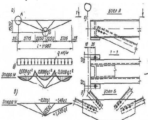
Сопряжения элементов в узлах выполняют на электрозаклепках или сварными швами, что создает высокую надежность при эксплуатации.
