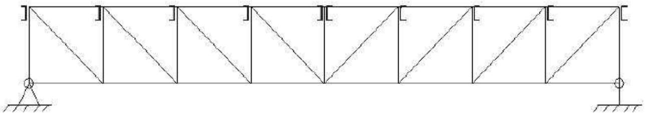
Рис.17.6. Расположение прогонов при использовании профилированного настила в качестве связей по верхнему поясу.
