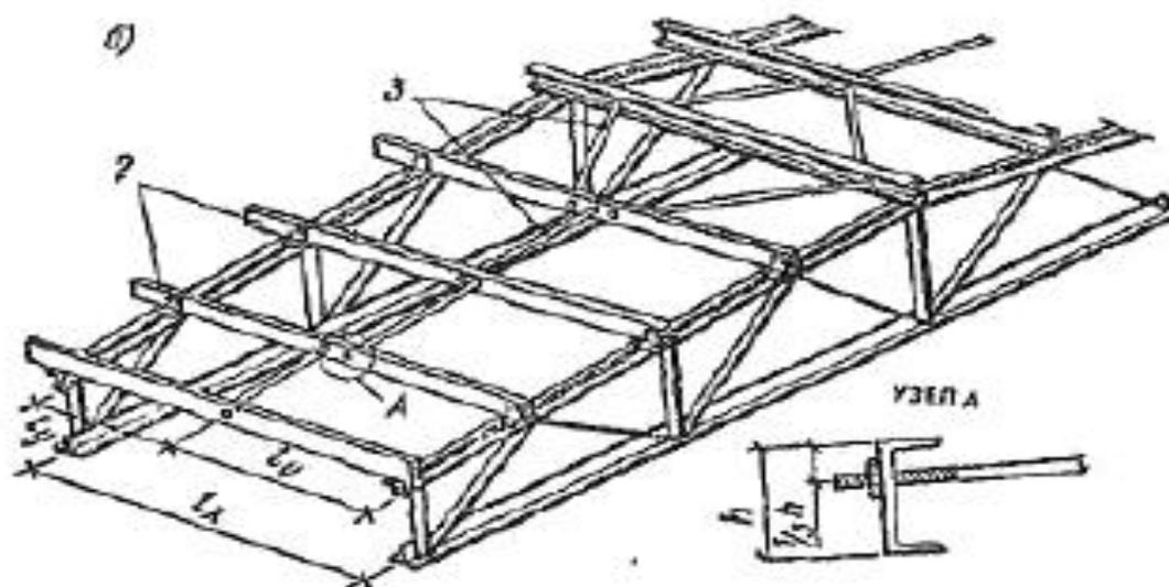
Рис. 22.4. Устройство тяжей.
