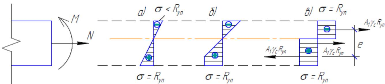
Очевидно, что разность площадей эпюр напряжений, умноженная на  $R_{yn}$ , равна предельной продольной силе:
