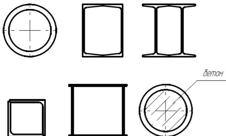
Рис. 13.2. Замкнутое сечение стержня колонн.
