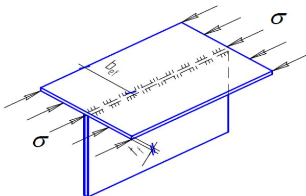
Сжатый пояс балки представляет собой длинную пластинку, шарнирно закрепленную одной стороной (вдоль стенки).
