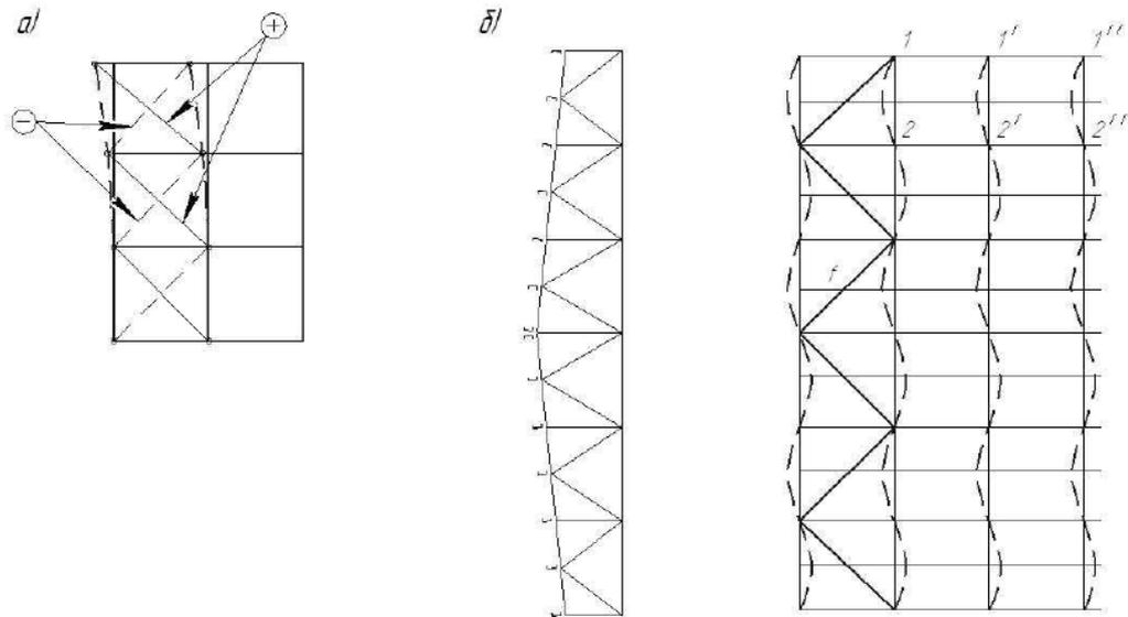
Рис. 17.4. а) Схема натяжения и выключения раскосов связей;
