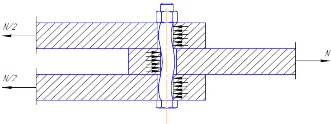
Болты класса точности В и С за счет зазора 2...3 мм работают неравномерно. 1 этап работы соединения – преодоление силы трения. Затем болты касаются стенок отверстия и работают частично на срез и частично на смятие.
