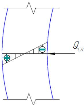
От случайной силы стержень изгибается, возникает изгибающий момент, и получаем следующую эпюру напряжений:
