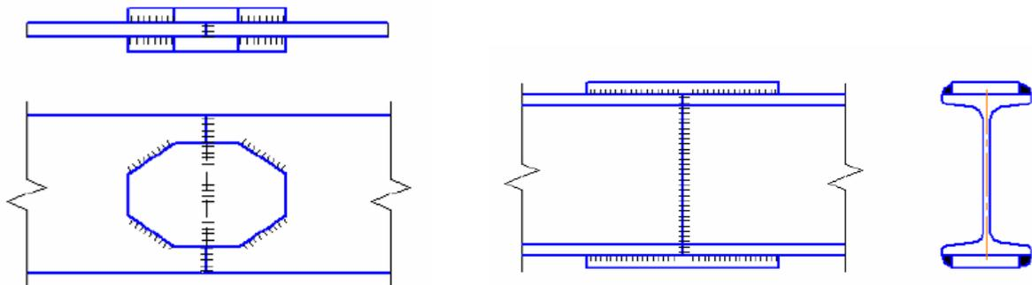
Соединения внахлёстку и с накладками отличаются простотой обработки элементов под сварку, но по расходу металла они менее экономичны, чем стыковые. Эти соединения также
