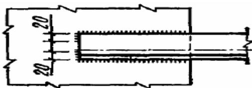
Рис. 20.5. Схемы выведения швов на торец элемента
