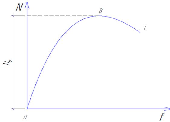
При постепенном повышении нагрузки напряжения более нагруженных фибр переходят в пластическую стадию; нейтральная ось при этом смещается в сторону выпуклых волокон (так же, как и при центральном сжатии). Критическое состояние перехода стержня из устойчивого в неустойчивое положение располагается в пределах развития пластических деформаций по сечению.
