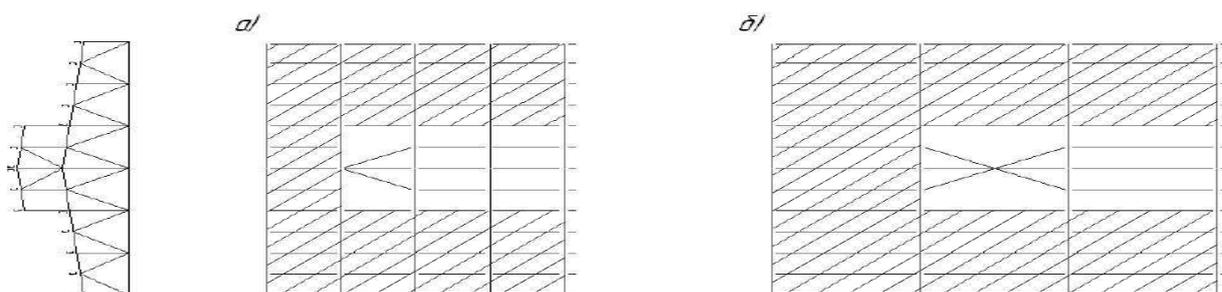
Рис. 17.7. Обеспечение устойчивости верхних поясов ферм под фонарями в покрытиях, где функции связей выполняет стальной настил: а) шаг ферм 6 м; б) шаг ферм 12 м.
