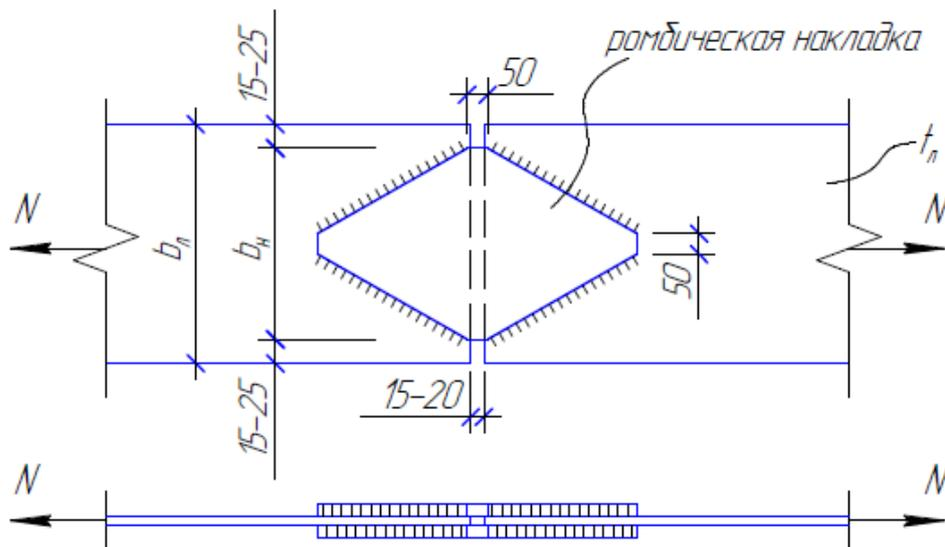
Порядок расчета соединения на ромбических накладках:
