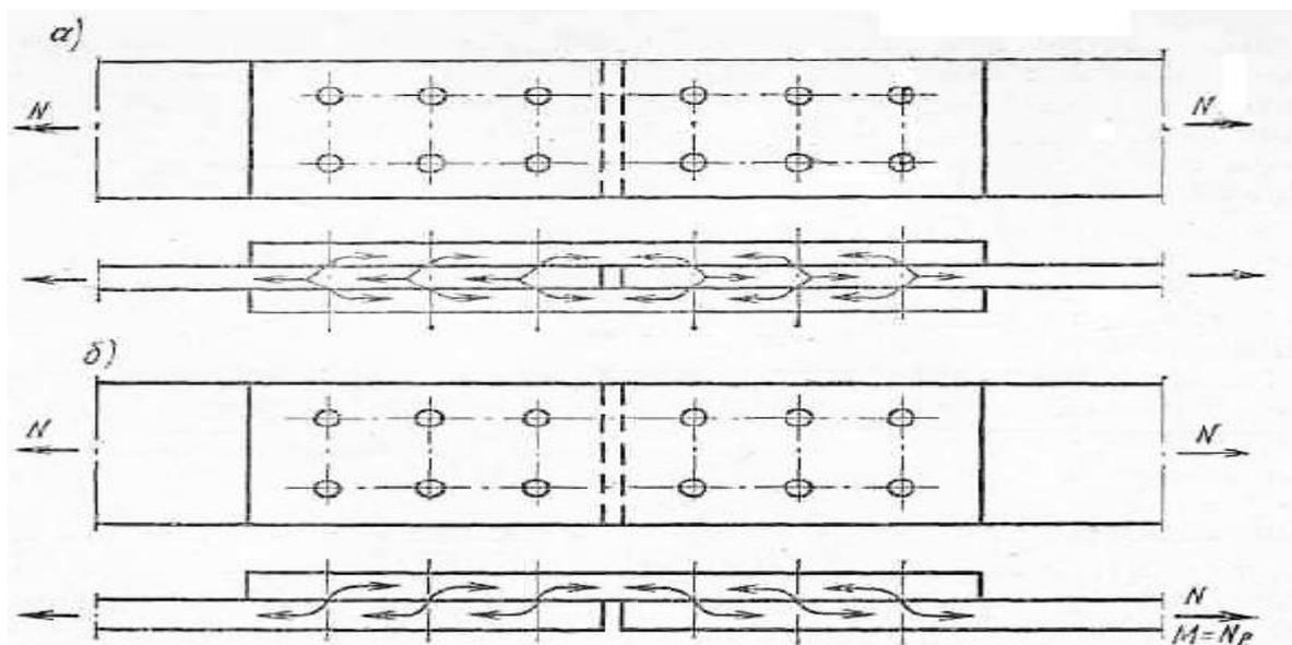
Рис. 10.1. Стыки листового металла
