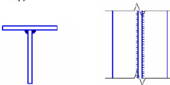
Угловые и тавровые соединения выполняют угловыми швами, они характеризуются простотой изготовления, высокой прочностью, экономичностью и широко применяются в конструкциях.
