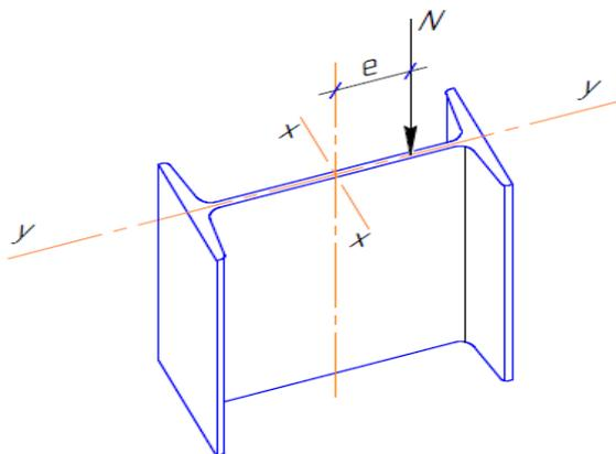
Для приведенного рисунка плоскость действия силы – это плоскость стенки двутавра.
