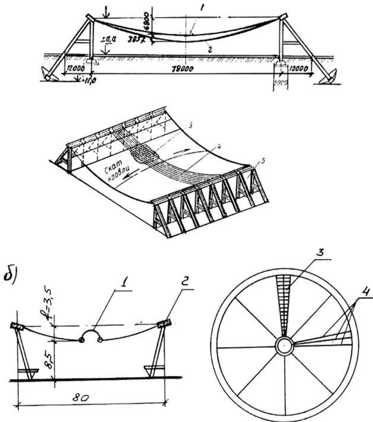
Рис. 16. Однопоясные покрытия с гибкими вантами:
