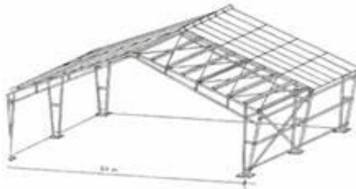
Рис.8. Каркас складского здания с деревянными клеефанерными рамами
