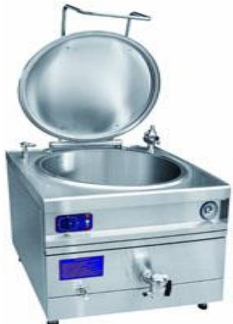
п. Пищеварочный котел состоит из двустенных цилиндрических сосудов, внешнего и внутреннего. Между стенками сосудов имеется пространство, называемое рубашкой, которое заполняется водой. Воду нагревает электронагреватель. В предприятиях общественного питания применяются пищеварочные котлы емкостью от 20 до 250 л.
