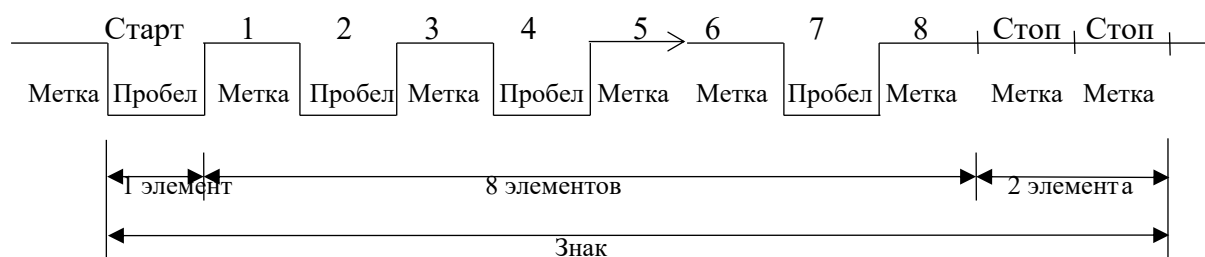
Рис. 2.1.1. Метка и пробел — элементы, с помощью которых передается знак телеграфного сигнала.
