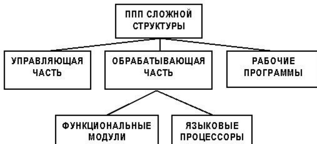
Рис. 3.5. Состав пакета прикладных программ сложной структуры
