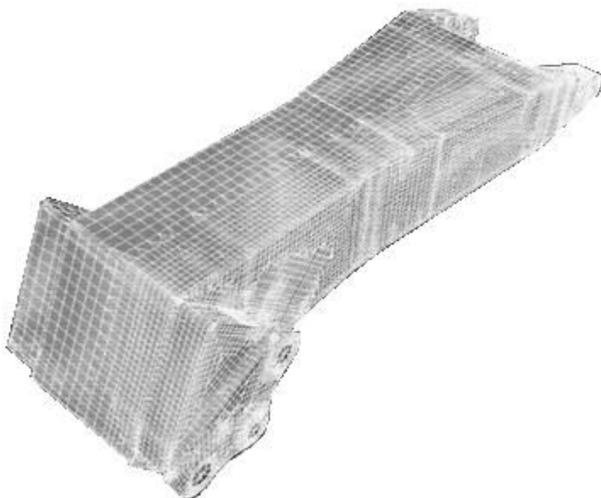
Рис. 5.2. Геометрическая модель рукояти карьерного экскаватора
