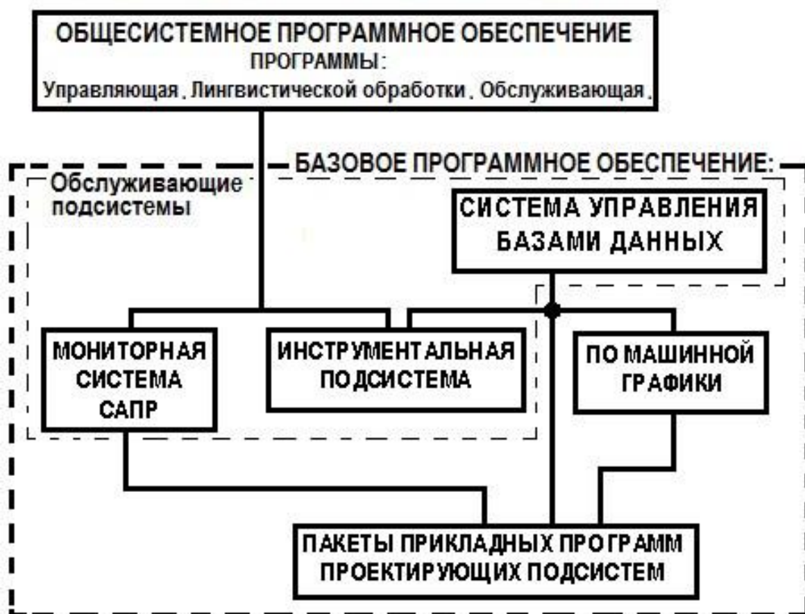
Рис. 3.4. Структура программного обеспечения САПР
