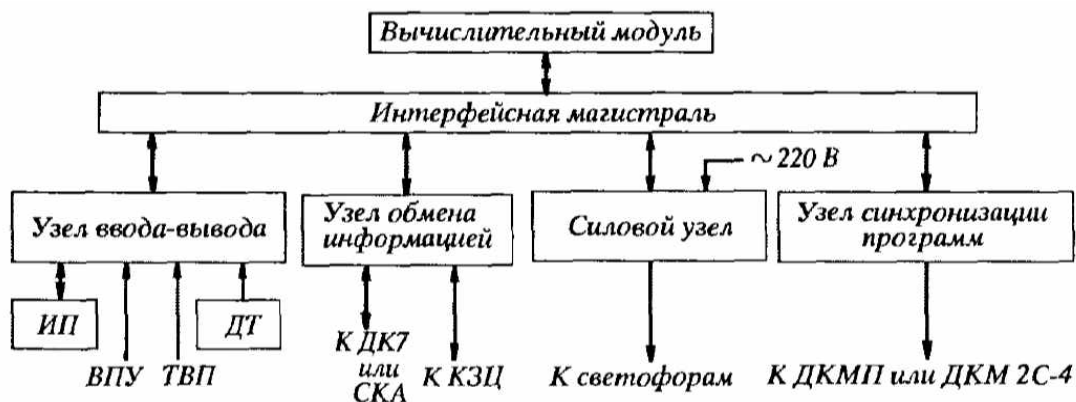
Рис. 8.6. Структурная схема контроллера ДКМП
