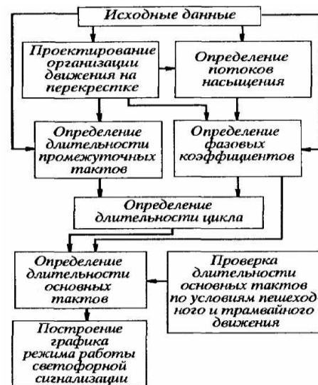
Рис. 6.9. Последовательность расчета длительности цикла и его элементов
