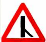
2.3.6 Примыкание второстепенной дороги
