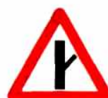
2.3.3 Примыкание второстепенной дороги
