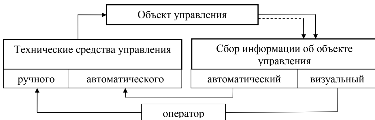
Рис.2.1. Структурная схема контура управления
