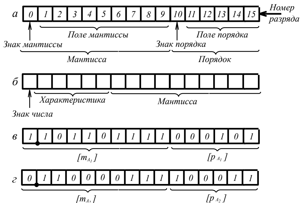
Рис. 6. Представление чисел в форме с плавающей запятой
