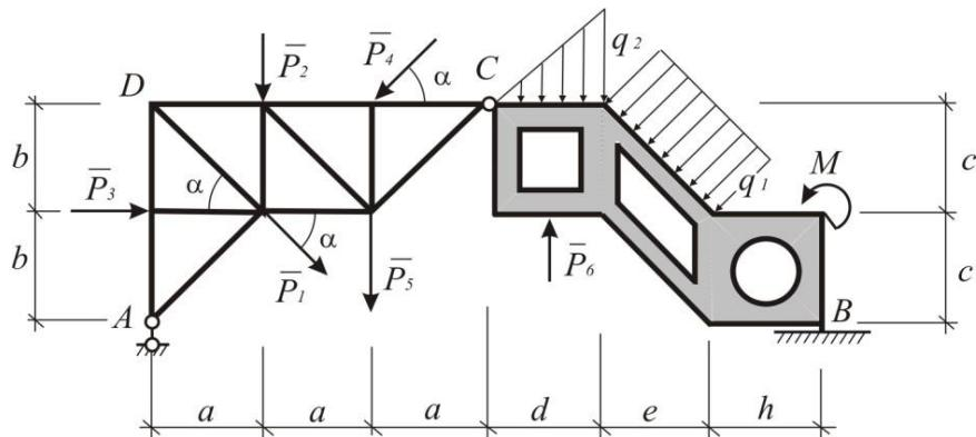
1. Пренебрегая собственным весом стержней и пластины, составить силовые схемы для конструкции в целом и для фермы и пластины в отдельности. Распределенную нагрузку заменить равнодействующей.
