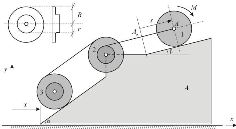
Каток1представляетсобойсплошнойоднородныйцилиндрмассы  $m_1=2m$  радиуса $r_1=2r$ .Блок2икаток3–одинаковыесплошныеоднородныесдвоенные цилиндрымассы $m_2=m_3=m$ с внутренним радиусом $r_2=r_3=r$ и наружным радиусом $R=R=2r$
