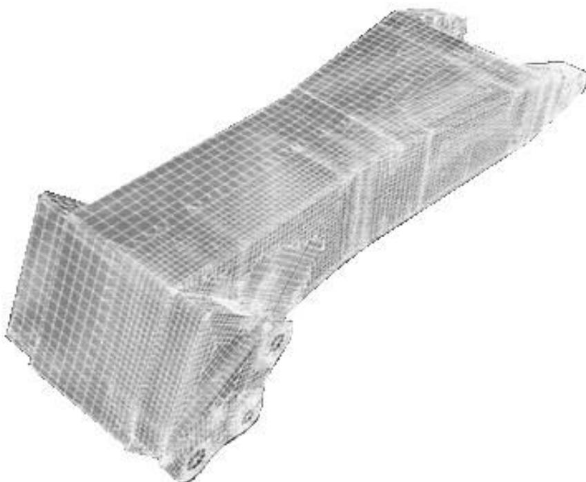
*Рис. 5.2. Геометрическая модель рукояти карьерного экскаватора*
