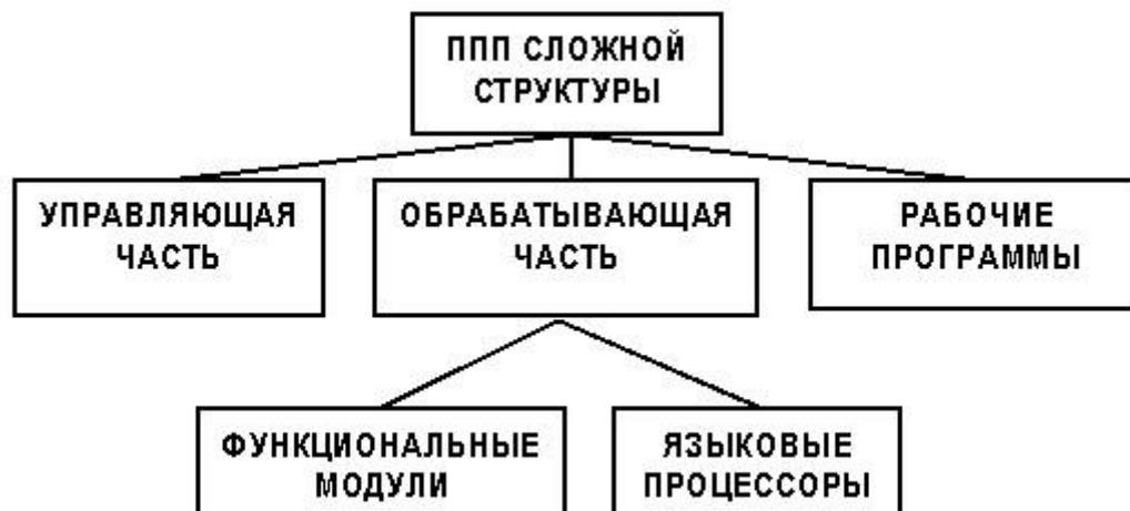
Рис. 3.5. Состав пакета прикладных программ сложной структуры
