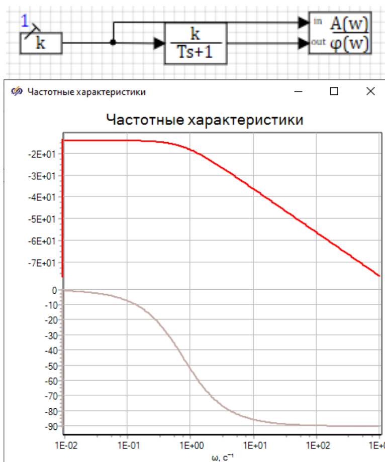
Рис.2.3. Исходный вид частотных характеристик интегратора
