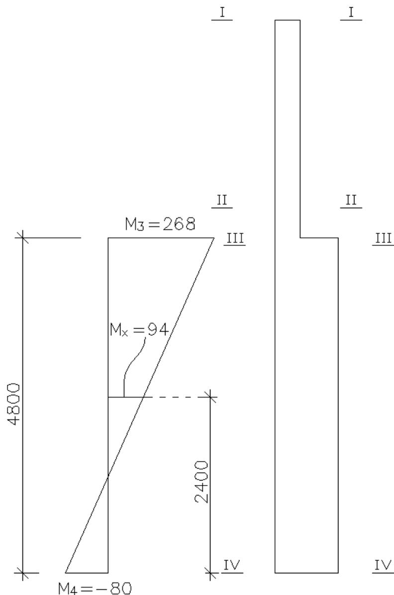
Рис.8. К определению расчетного момента  $M_x$
