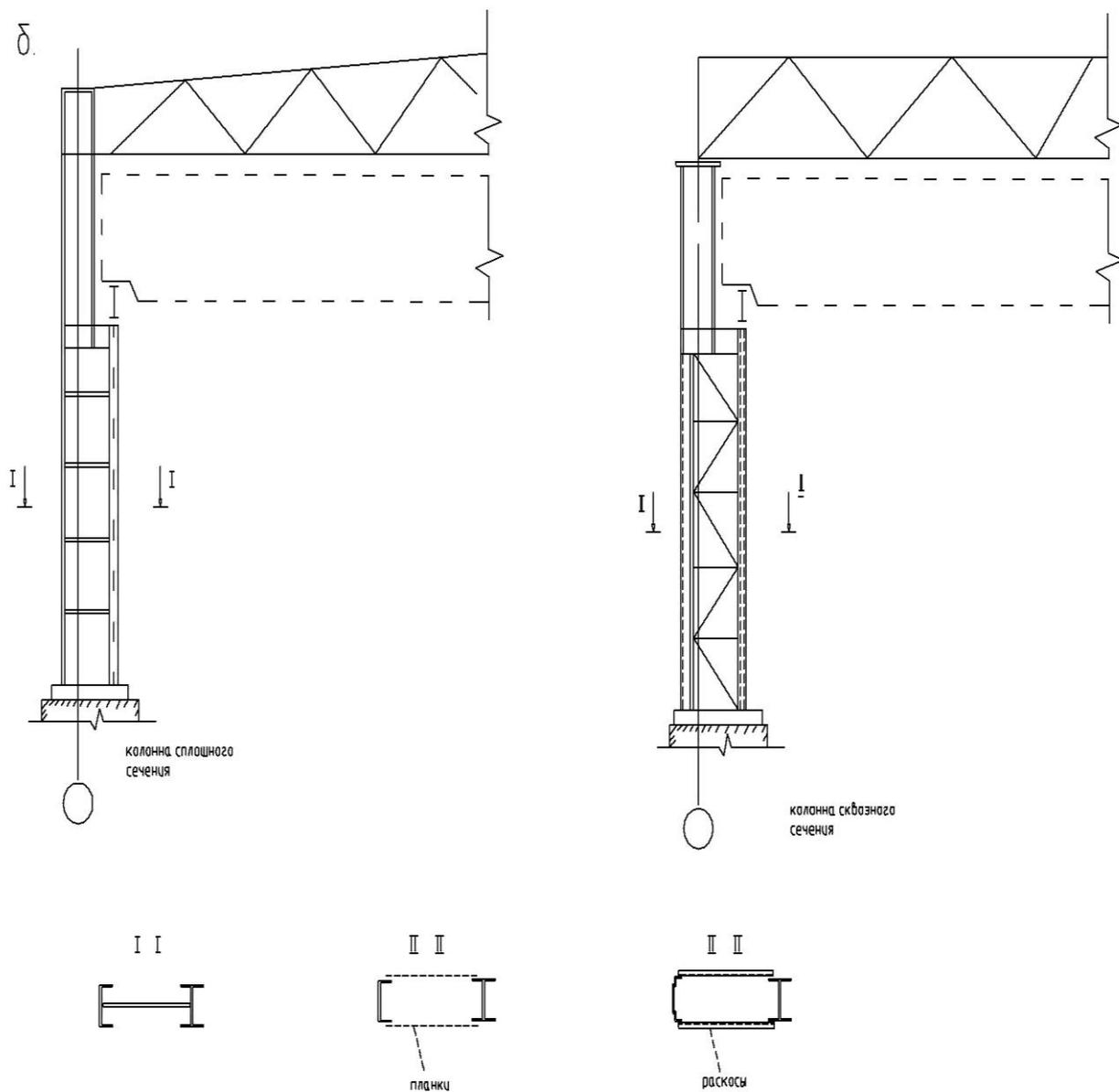
Ступенчатые колонны, основной тип колонн – способный нести  $Q = 300 \div 400$  тонн – грузоподъемность мостового крана.
