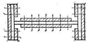
Монтажный стык ступенчатой колонны
