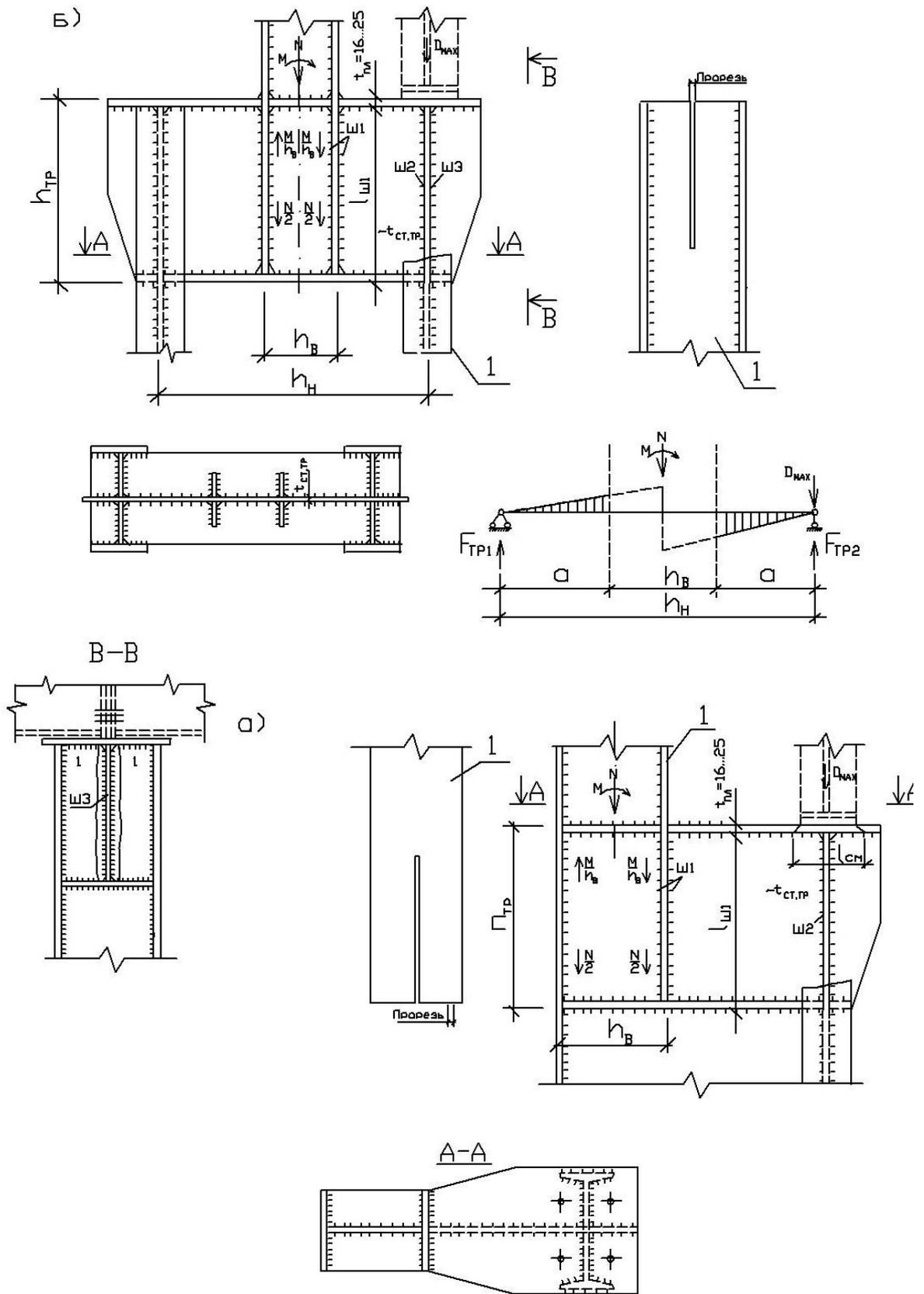
Узлы сопряжения верхней и нижней части колонн
