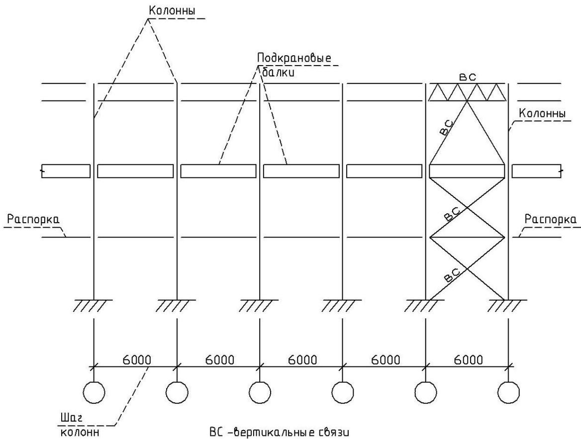
Рис.9. Схема расположения распорок между колоннами.
