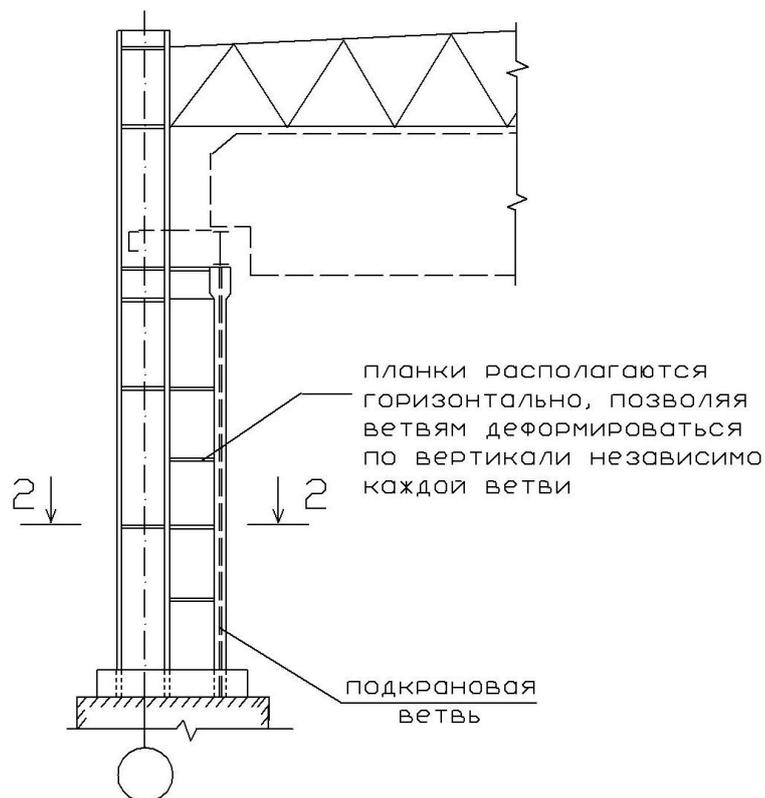
Подкрановая ветвь несет только вертикальную нагрузку от мостового крана;
