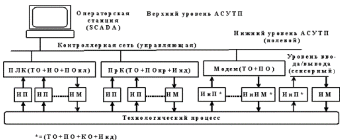
Рис.8.1. Типовая функциональная схема современной АСУ ТП.
