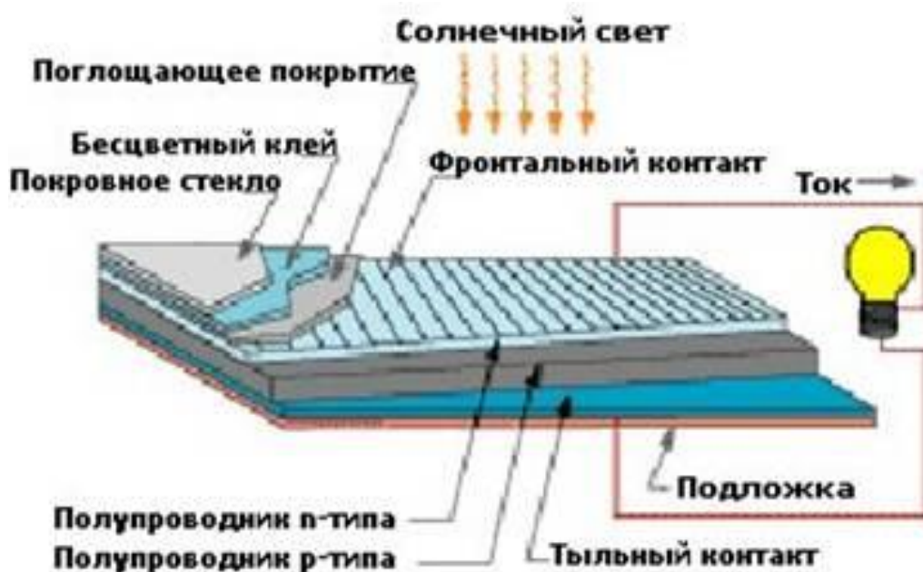
Рис. 4.6. Конструкция фотоэлемента
