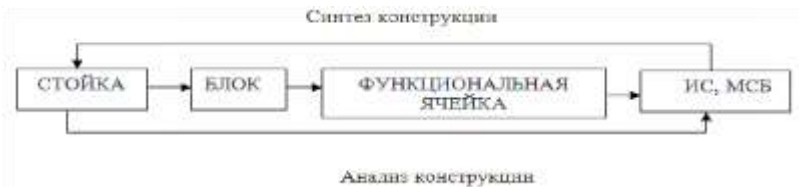
Рис. 2. Принцип системности в процессе конструирования
