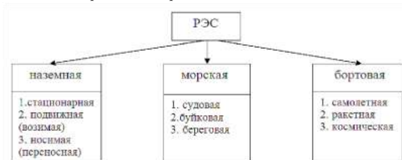
Рис. 8. Классификация РЭС по конструктивному исполнению
