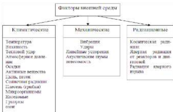
Рис. 10. Факторы, воздействующие на работоспособность РЭС
