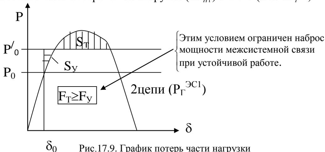
Рис.17.9. График потерь части нагрузки
