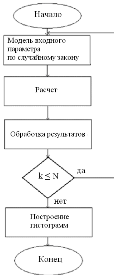
Рис. 7.6. Структурная схема алгоритма статистического анализа: N – число статистических расчетов; k – номер очередного расчета
