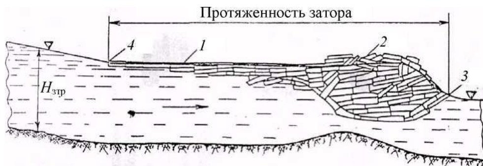
Рис. 7.9. Продольный разрез затора льда: 1 - хвостовая часть затора (хвост затора); 2 - головная часть затора (голова затора); 3 - нижняя кромка (нижняя граница затора); 4 - верхняя кромка (верхняя граница затора); H_{зтр} - высота затора
