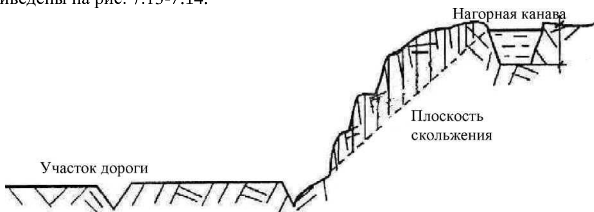
Рис. 7.13. Нагорная канава для отвода поверхностных вод от оползневого участка
