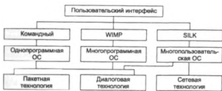
Рис. 1.2 - Классификация информационных технологий по виду пользовательского интерфейса
