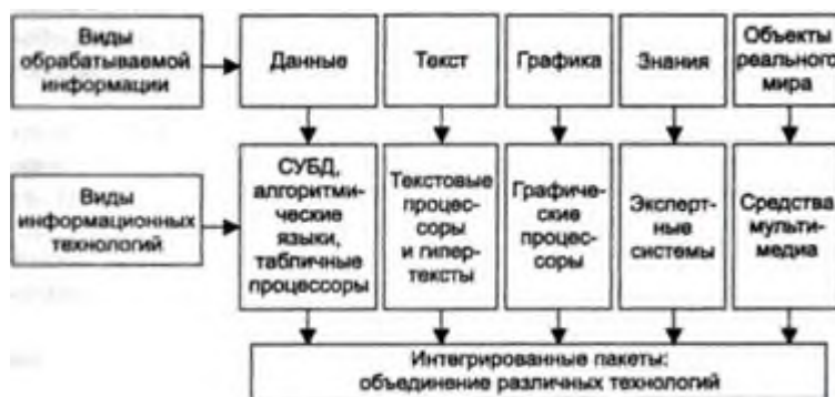
Рис. 1.1 - Классификация информационных технологий в зависимости от вида обрабатываемой информации
