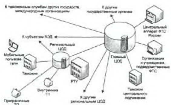
Рис. 1.5 - Схема основных типовых узлов ЕАИС
