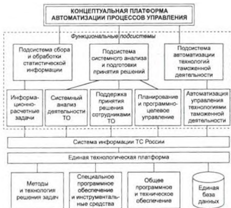
Рис. 1.3 - Структурно-функциональная схема автоматизации процессов управления таможенной службой
