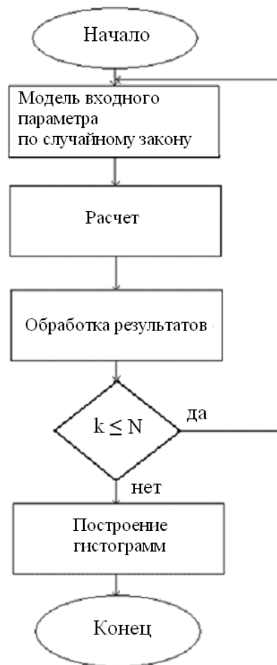
Рис. 7.6. Структурная схема алгоритма статистического анализа: N – число статистических расчетов; k – номер очередного расчета
