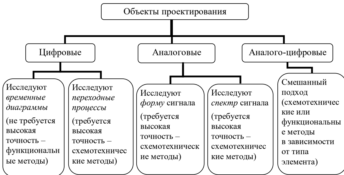
Рис. 6.1. Объекты схмотехнического проектирования и применяемые методы
