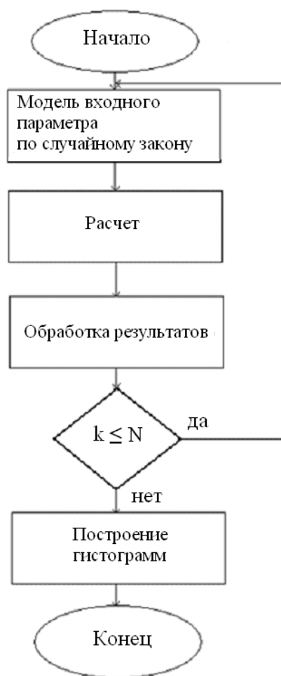
Рис. 7.6. Структурная схема алгоритма статистического анализа:
