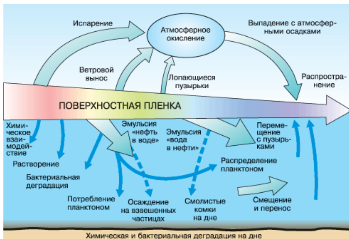
Рисунок 8.2 - Схема процессов распределения и разрушения нефти, разлитой в море
