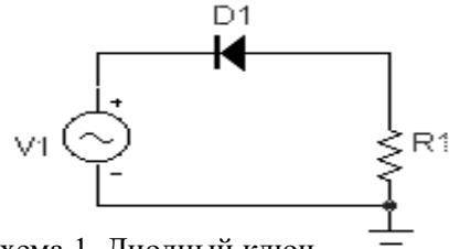
Схема 1. Диодный ключ. V1 – 80 Гц, 6В D1 – 1N3017A; R1 – 1k
