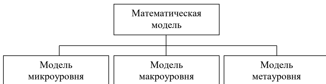
Рис. 9 – Схема классификации математических моделей по принадлежности к иерархическому уровню
