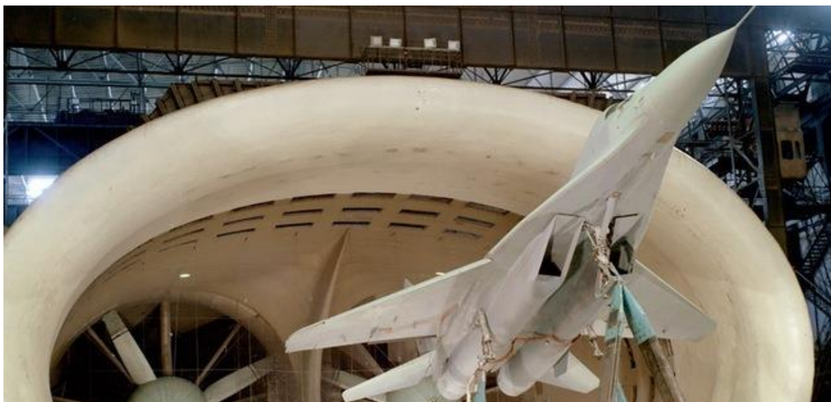
Рис. 7 – Фото самолет МиГ-29 в аэродинамической трубе Т-101
