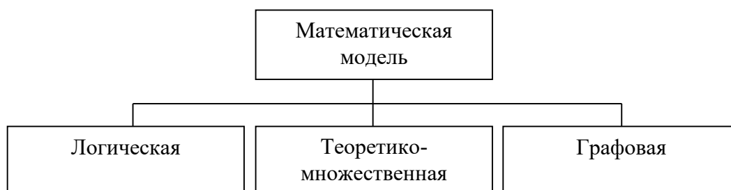
Рис. 13 – Схема классификации математических моделей по форме представления свойств объекта
