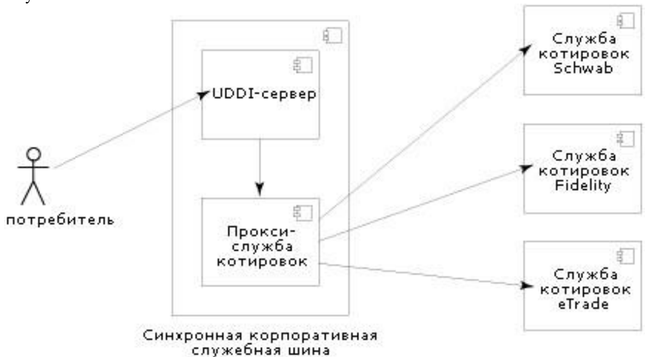
Рисунок 8.4 — Синхронный вызов через брокера
